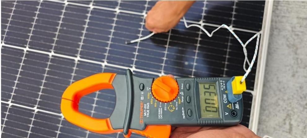
*Figura 34 medición de la temperatura del panel solar.*
