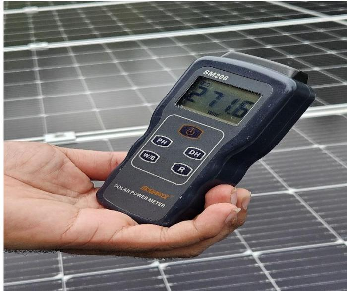
Figura 32 medición de la radiación solar.
