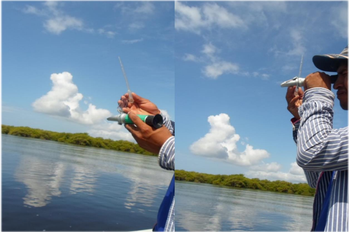
Figura 7. Refractómetro VITAL SINE SR-6 para obtener la cantidad de salinidad.
