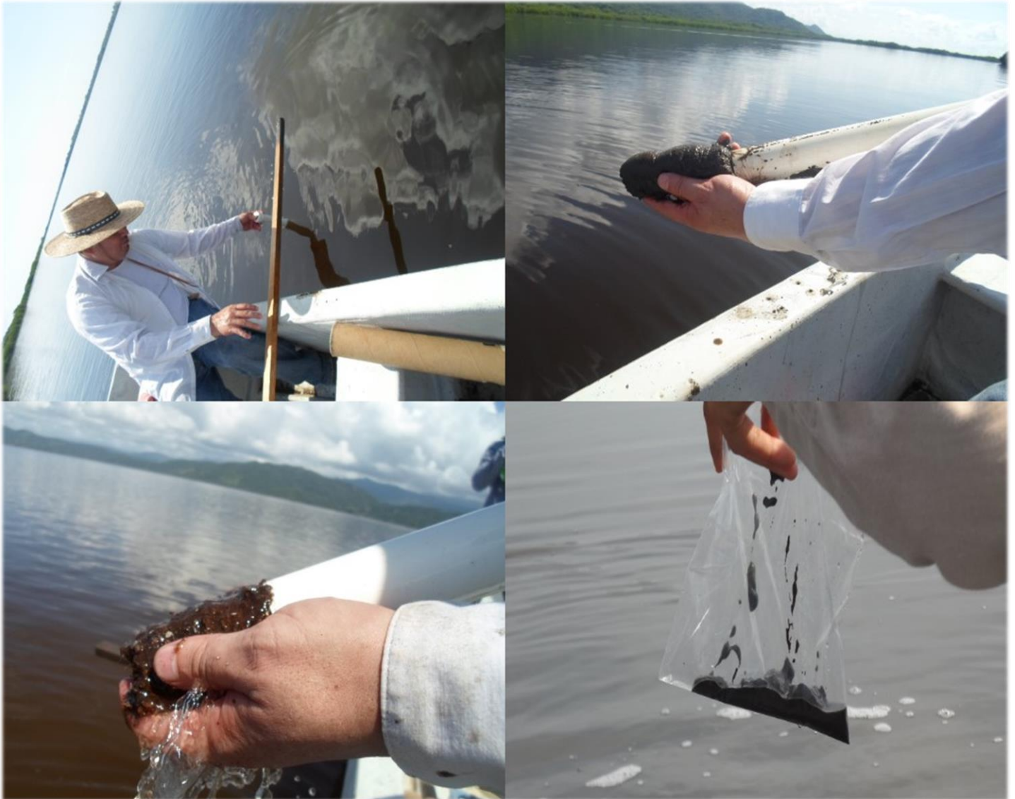
Figura 12. Extracción de muestra de sedimento con tubo de PVC al vacío, identificación y obtención de cada una de ellas.
