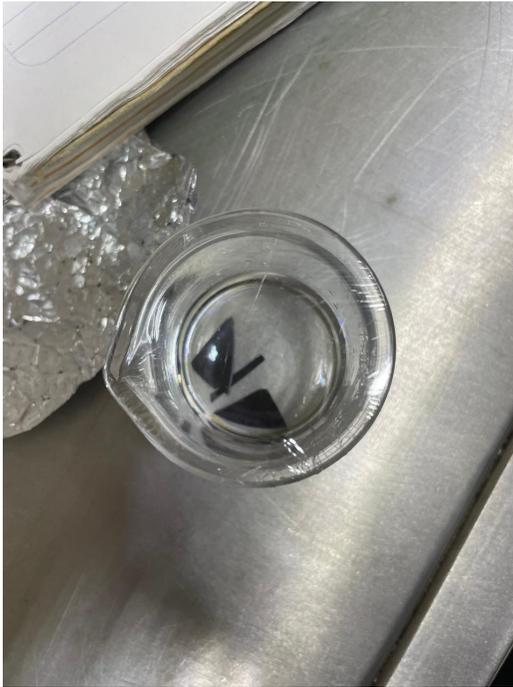
Figura 3.3 Oblea sumergida en acetona, metanol y agua desionizada respectivamente
