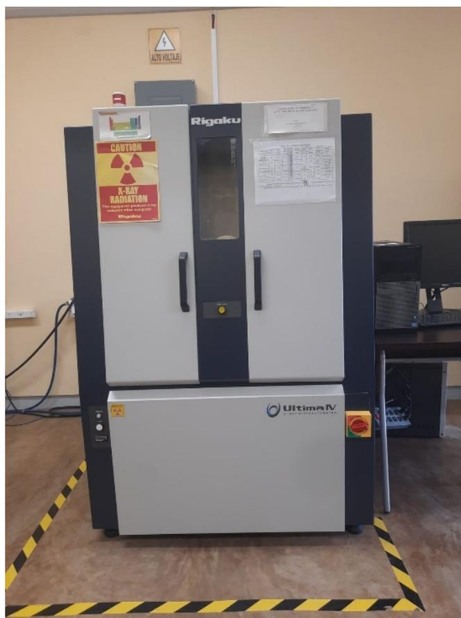
*Figura 3.9 Difractómetro de Rayos X*
