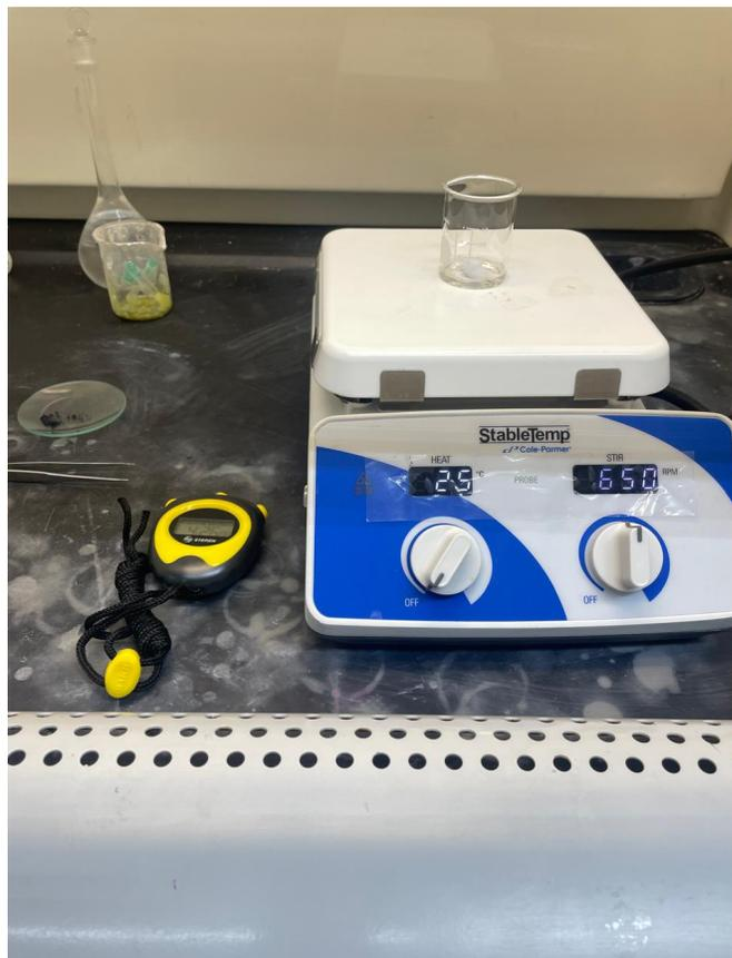
*Figura 3.10 Se deja agitando durante 20 minutos a 650 rpm para permitir la dispersión homogénea*
