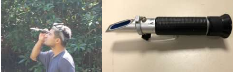
Figura 10. Toma de salinidad con refractómetro.
