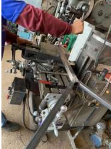
Imagen 33. Perforación de bases para el armado de toda la estufa.
