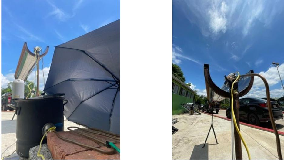
*Ilustración 51. Medición de temperatura del sistema solar térmico con la integración de un concentrador reflejante en día despejado*
