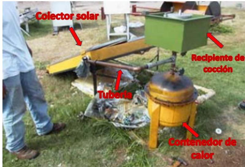
Ilustración 17. Estufa solar indirecta con colector plano
