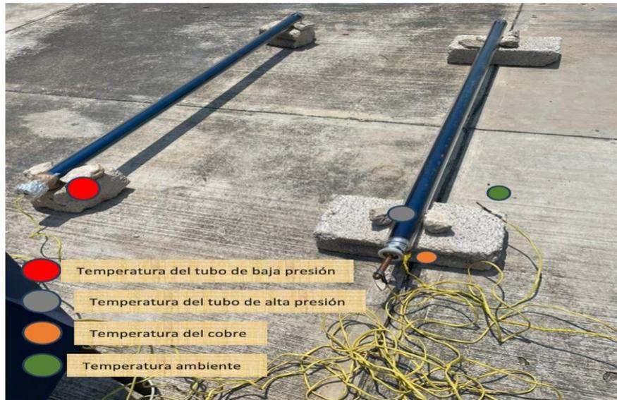
*Ilustración 38. Posicionamiento de termopares en el sistema*
