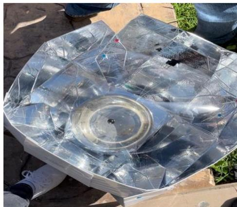
Ilustración 11. Estufa solar directa tipo panel
