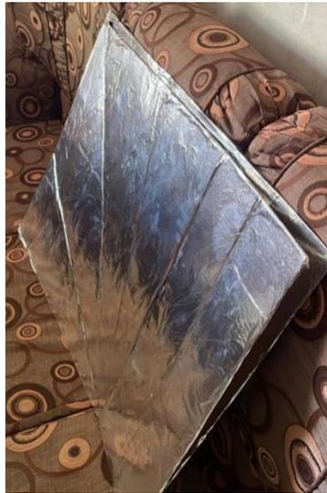
*Ilustración 12. Estufa solar directo tipo panel con material reciclado*
