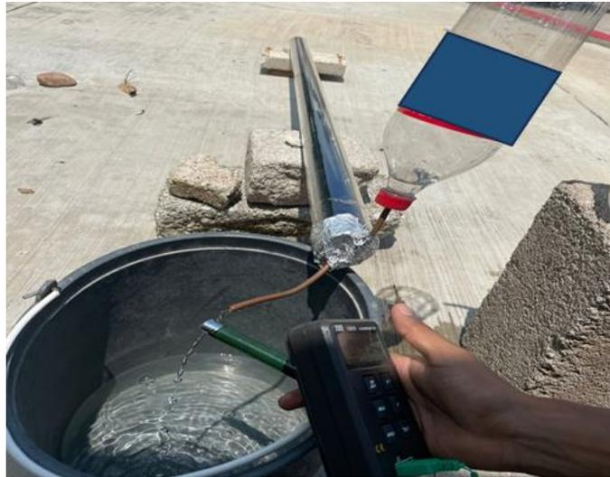
Ilustración 43. Sistema de calentamiento de agua usando un tubo al vacío de baja presión
