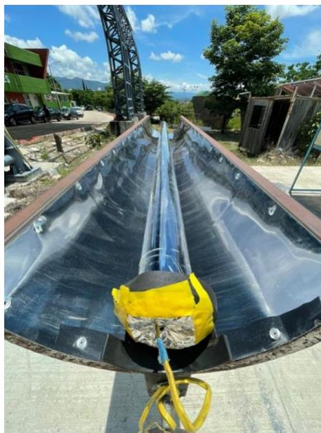
*Ilustración 16. Estufa solar directa tipo cilíndrico parabólica*
