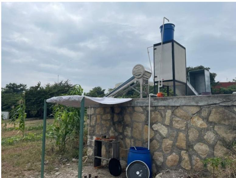
Ilustración 2. Prototipo experimental de la estufa solar
