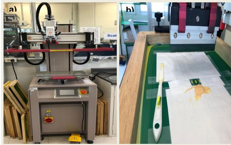
Figura 3.14 a) Equipo de screen printing (serigrafía) y b) Formación del plasma
