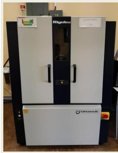
*Figura 3.25 Equipo de medición de difracción de rayos X (RIGAKU modelo ULTIMA IV)*
