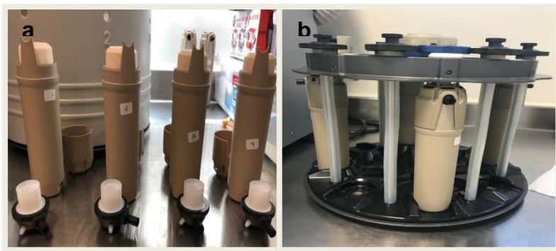
Figura 3.9 Preparación del reactor, a) Vasos de presión abiertos y b) Colocación de los vasos de presión en el rotor o carrusel del reactor.
