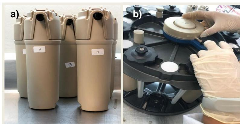
Figura 3.11 Rotor del equipo de microondas asistida, a) Vasos de presión y b) Ensamble de los vasos de presión
