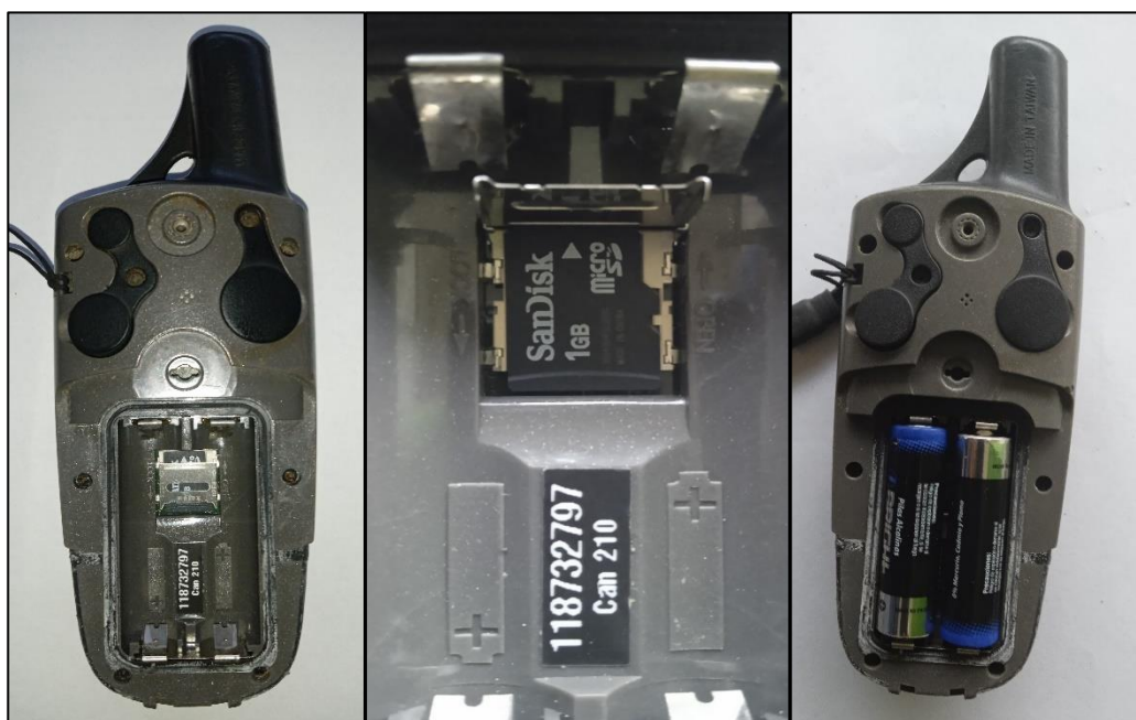
Figura 8. Nódulo de pilas, tarjeta de memoria y puertos de salida del GPSmap 60CSx
