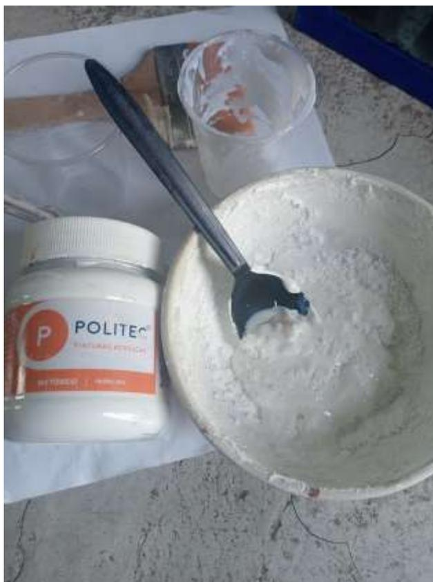
2 mezcla Carbonato de sodio, sellador 5x1 y pintura acrílica blanca, en partes iguales.
