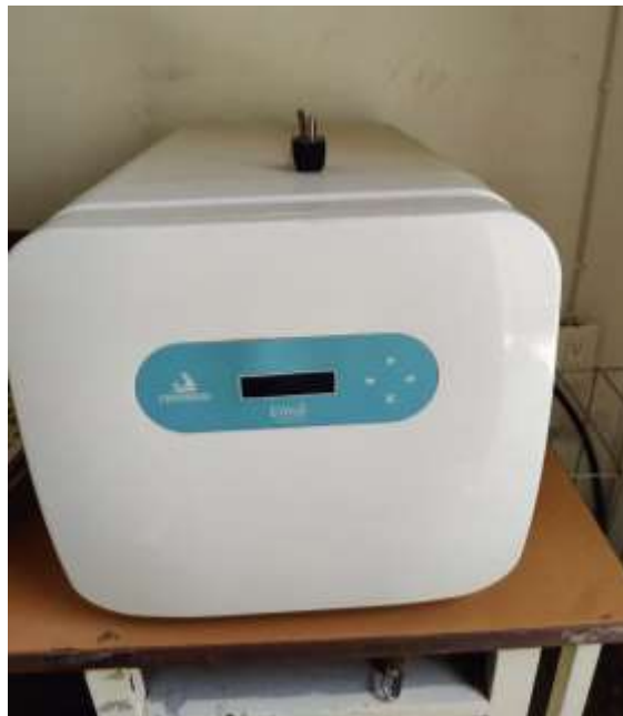
Ilustración 9. Autoclave para esterilización a vapor sobre presión dentro del almacén temporal. Fuente propia.
