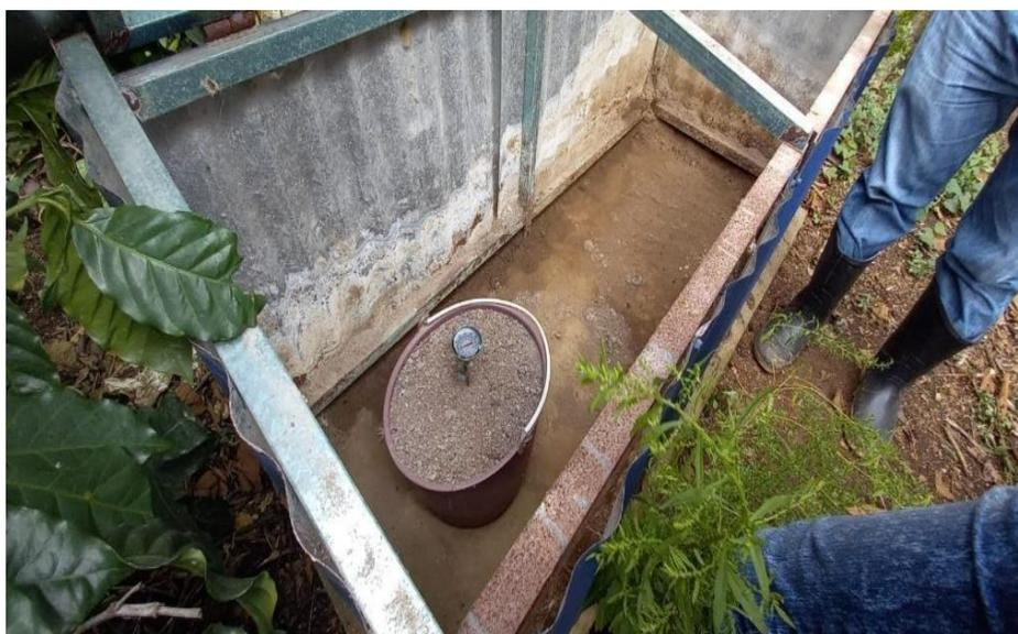
Figura 14. Registro de temperatura en una muestra de biosólido dentro del depósito de almacenamiento.
