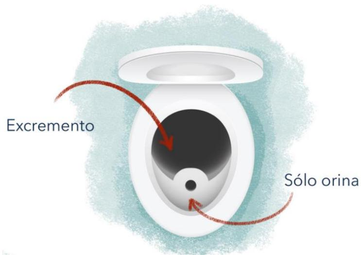
Figura 12. Taza con división para orina y heces instalados en los SES de El Mirador, Berriozábal, Chiapas (Rivera-Parra, 2022).
