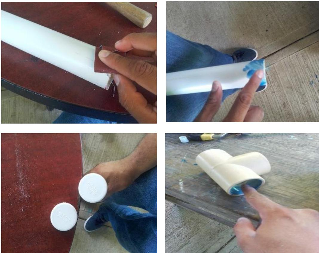
**Figura 51.** Proceso de construcción del mecanismo giratorio exterior del sistema de homogenización.
