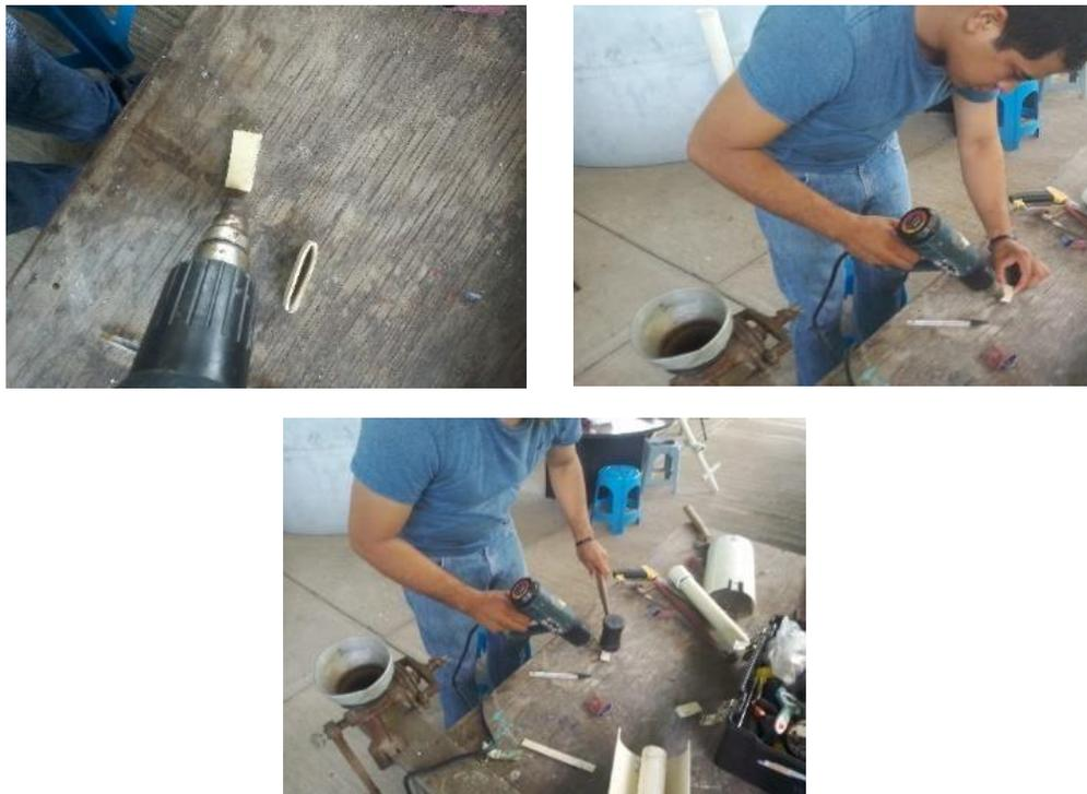
**Figura 40.** Procedimiento de fabricación de las pestañas.
