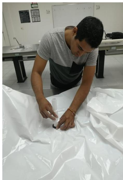
**Figura 69.** Unión de la tuerca y el empaque a su céspol a través de la bolsa.
