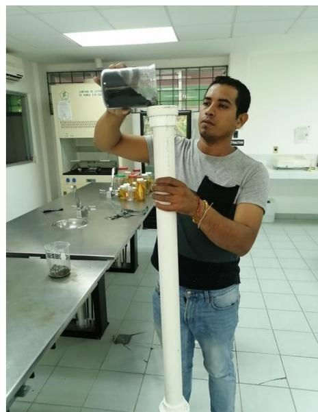
**Figura 63.** Adición del carbón activado granulado y limadura de hierro en el filtro.
