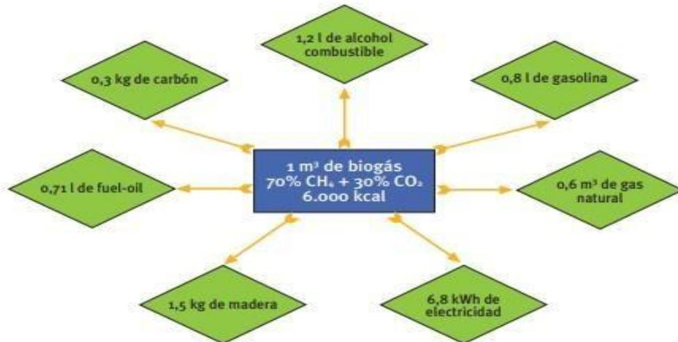
**Figura 9.** Equivalencias de biogás con otras fuentes de energía. Fuente: CIEMAT citado en IDAE y Besel, S.A., 2007.
