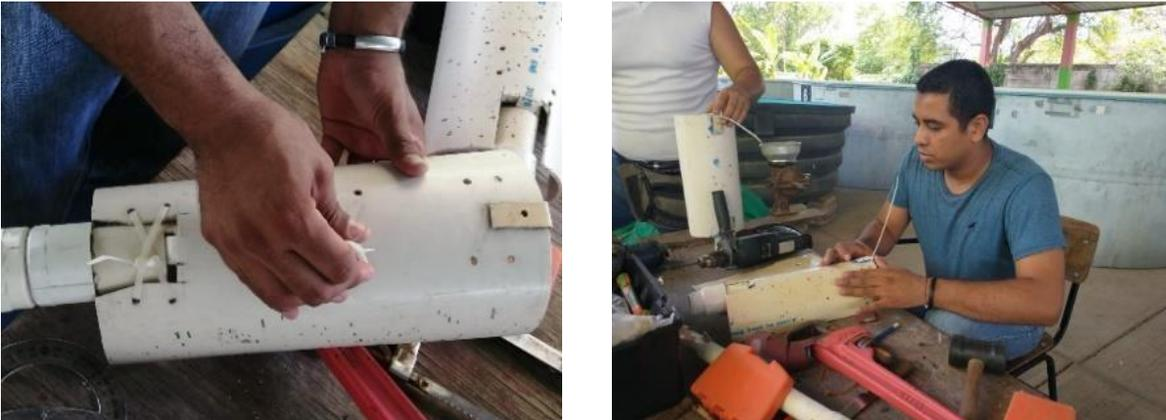
**Figura 45.** Atado de los cintos a través de los orificios hechos en el aspa.
