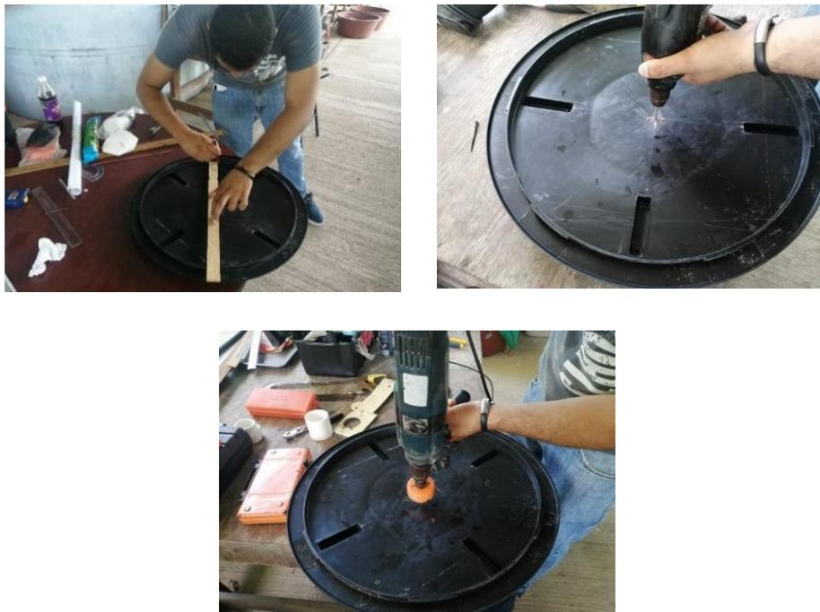
**Figura 24.** Trazo y perforación del centro de la tapa con brocas finas y circulares.
