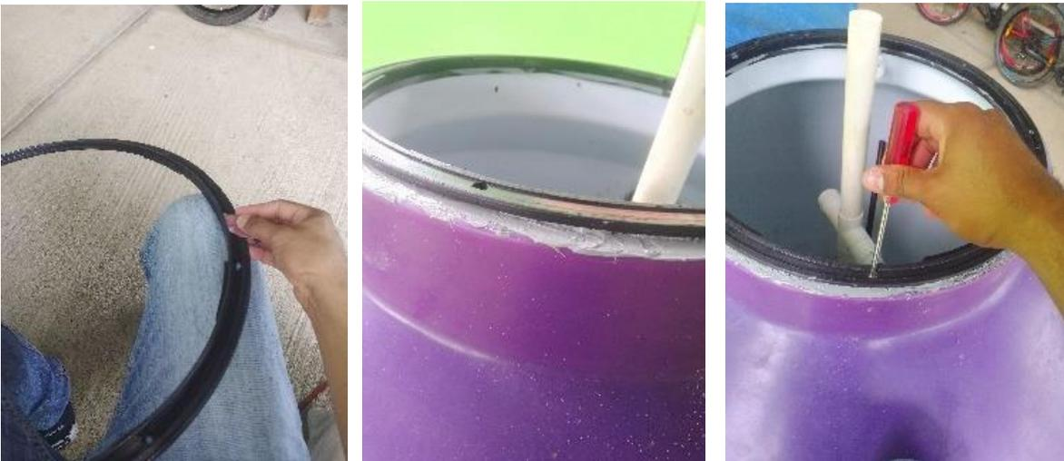
**Figura 53.** Lijado, ensamblado y atornillado del arillo.
