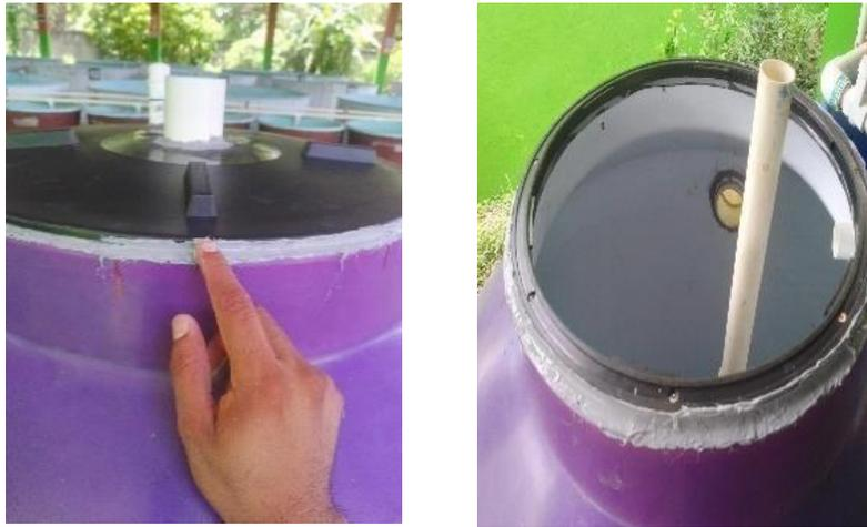
**Figura 54.** Aplicación del sellador gray por el borde de la boca del contenedor y sellado de este mismo.
