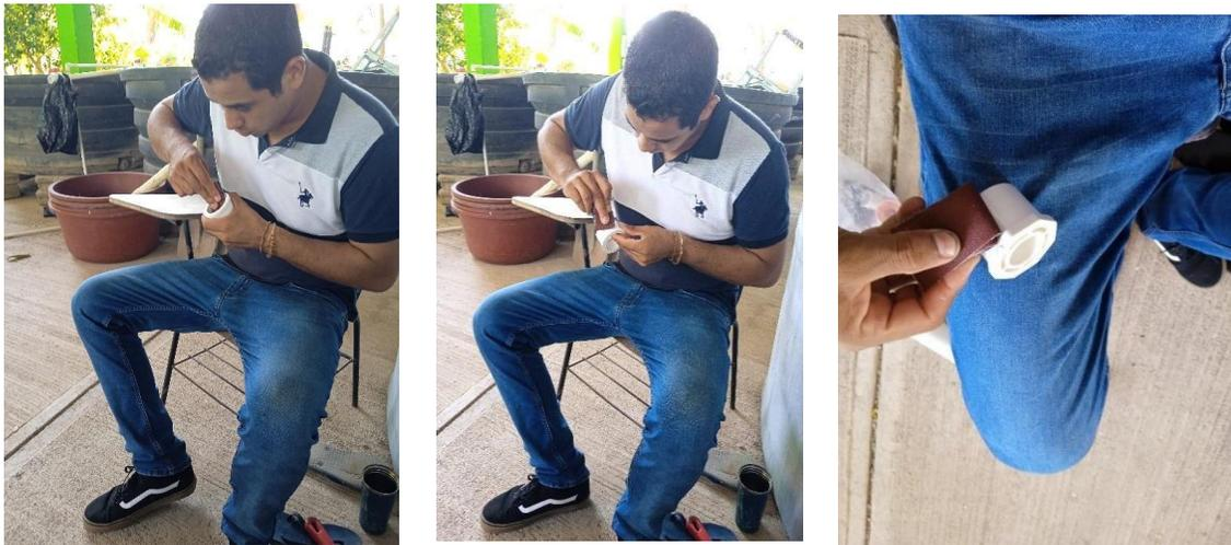
**Figura 59.** Lijado de las reducciones por el interior y exterior de estas mismas.
