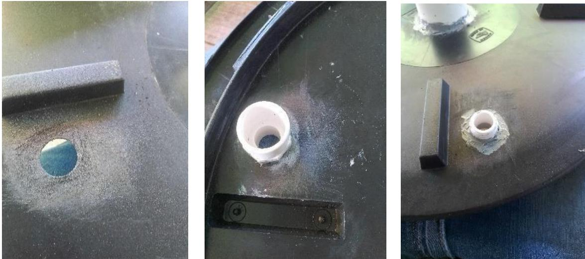
**Figura 22.** Lijado alrededor de la perforación e instalación del cree macho visto por fuera y dentro de la tapa.
