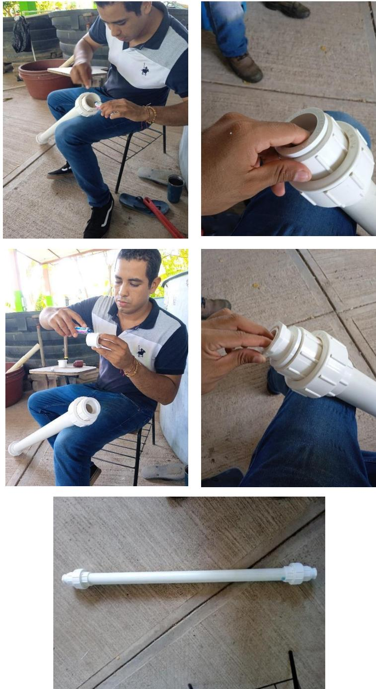
**Figura 60.** Ensamblado de las reducciones.
