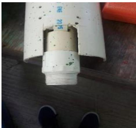
**Figura 42.** Insertado de la pestaña (hecha en el aspa) a la ranura realizada en el tubo de 1/2".
