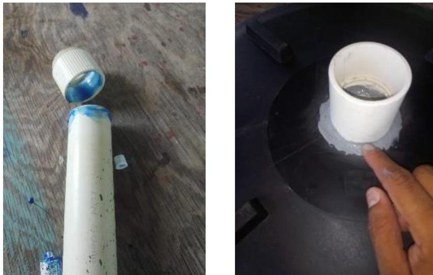
**Figura 29.** Pegado del tubo de PVC al cree macho de 2" y posterior unido al cree hembra a la tapa y cree macho
