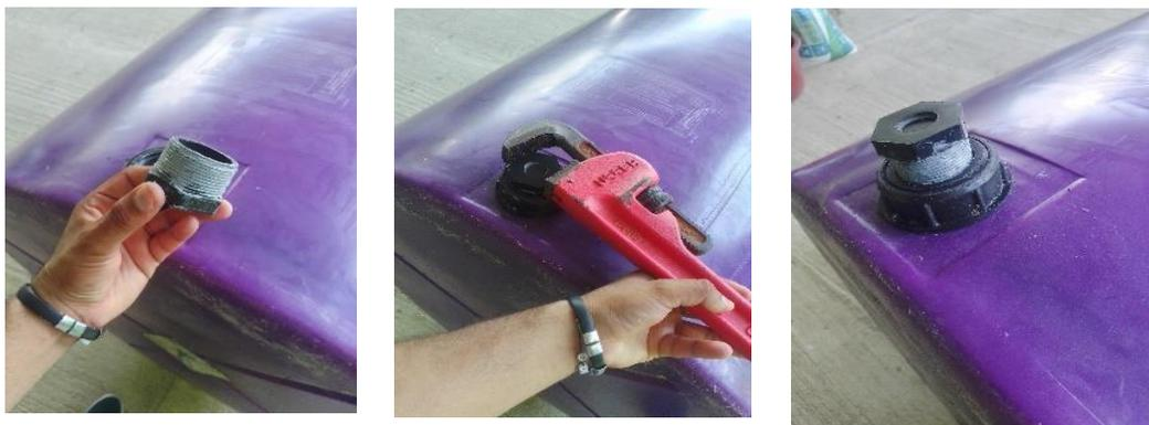
**Figura 55.** Aplicación de sellador Gray y ensamble del tapón roscable.
