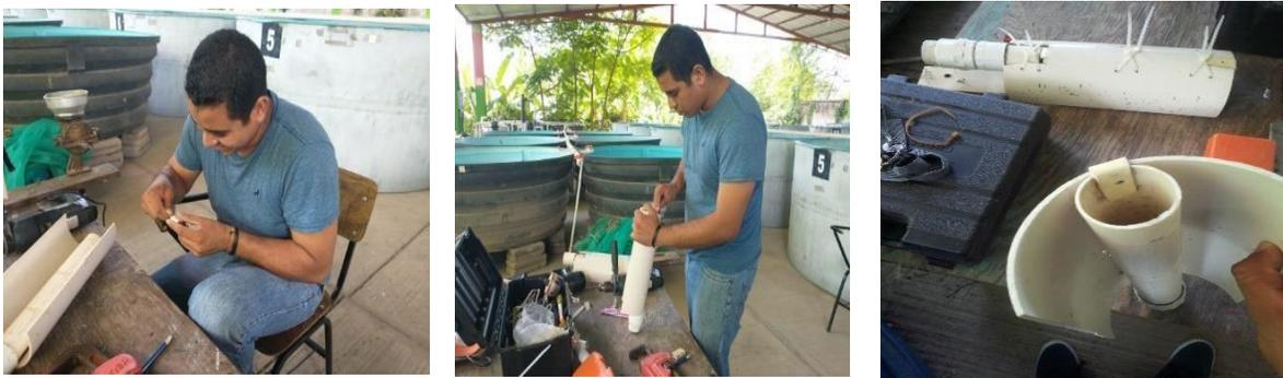
**Figura 44.** Lijado de la pestaña y ensamblado a las estructuras.
