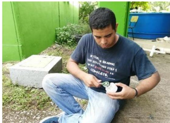
**Figura 35.** Introducción del tornillo y rondana en el tapón.
