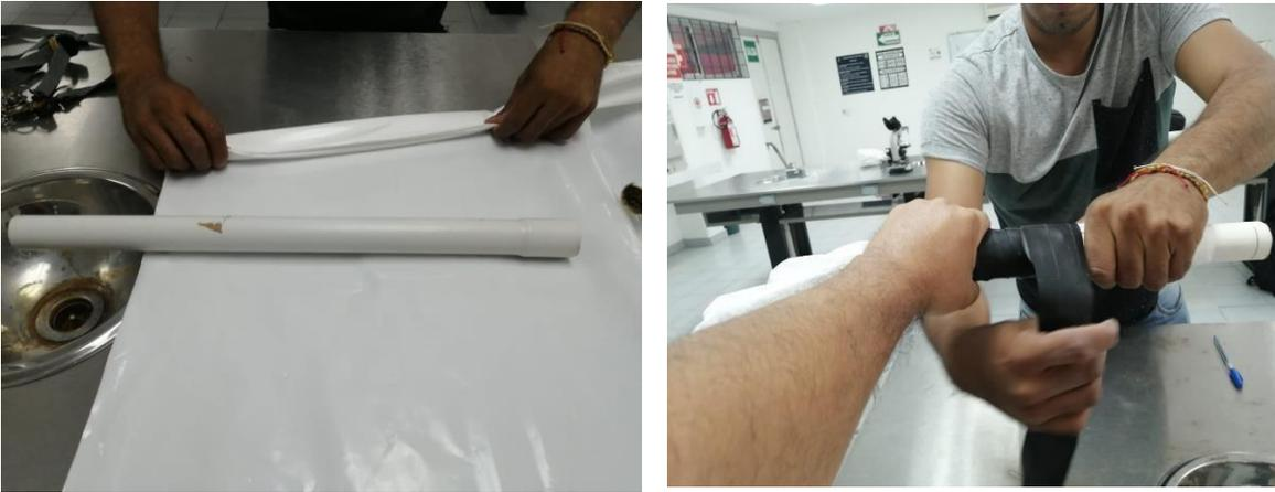
**Figura 70.** Proceso de ensamble del segundo tramo de tubo en el otro extremo y amarre de la cámara de llanta.
