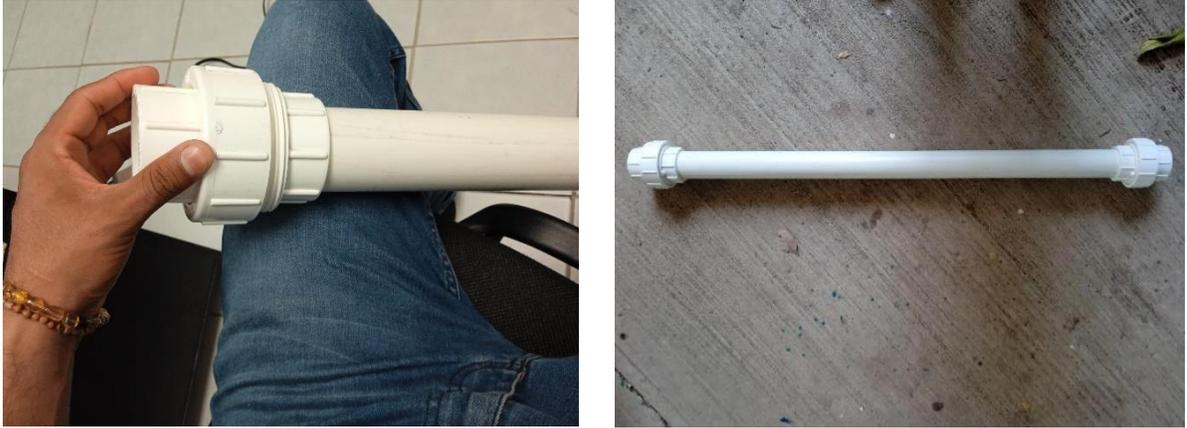
**Figura 58.** Anexión del tubo de PVC H. a las tuercas-uniones
