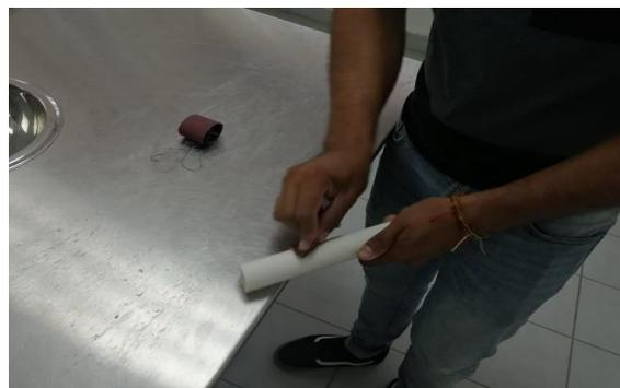
**Figura 64.** Recorte y lijado del tubo de PVC H
