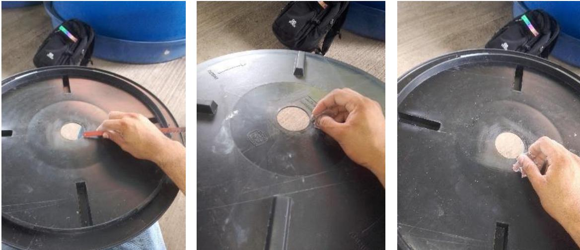
**Figura 26.** Desgaste de la superficie aledaña a la perforación.
