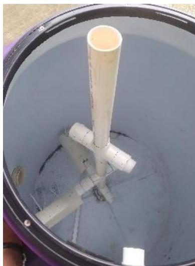
**Figura 50.** Instalación del sistema de homogenización, sobre el eje central del contenedor.
