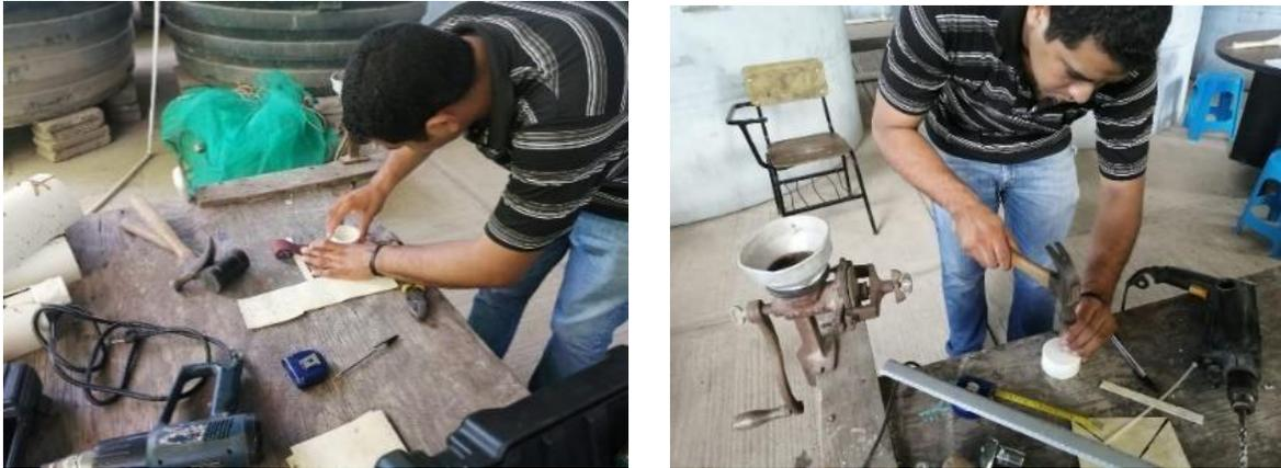
**Figura 34.** Lijado del tapón y perforación con ayuda de tornillo y taladro.
