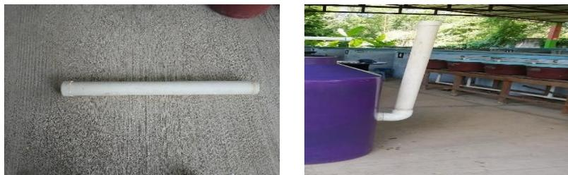
**Figura 14.** Ensamble del tubo de PVC de 130 cm y roscado del tapón.
