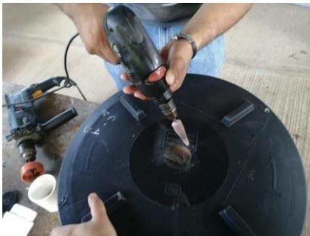
**Figura 25.** Desbaste del orificio con apoyo de la piedra pulidora.
