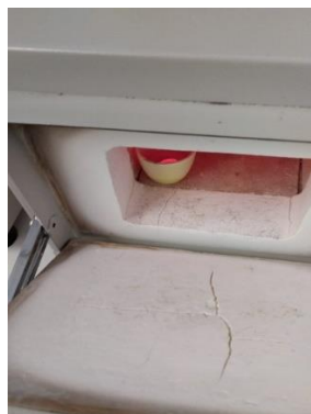
Figura 41. Convertir a ceniza en la mufla.
