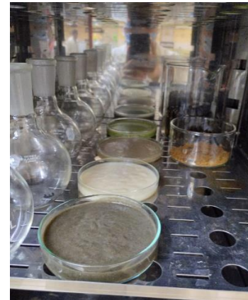
FIGURA 36. MUESTRAS EN EL HORNO DE SECADO
