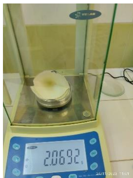
FIGURA 54. PESADO DE PAPEL FILTRO CON FIBRA.
