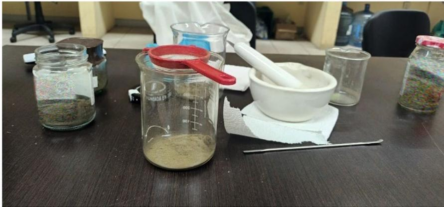
**Figura 8.** Imagen del triturado y tamizado del polvo extraído de cada proceso de extracción experimental: Alga-H<sub>2</sub>O, Alga-C<sub>2</sub>H<sub>6</sub>O y Alga-NaHSO<sub>3</sub>.
