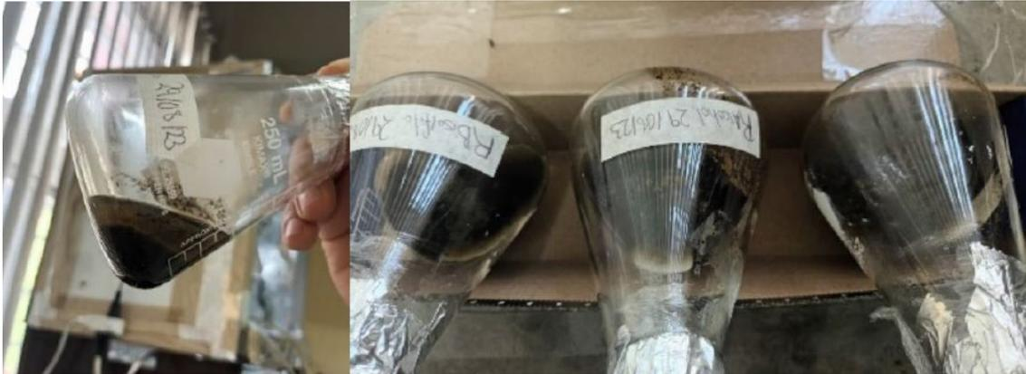
**Figura 10.** Imagen del tratamiento con NaOH para la eliminación de residuo lignocelulosicos, clorofila y proteínas adheridas al polvo extraído.
