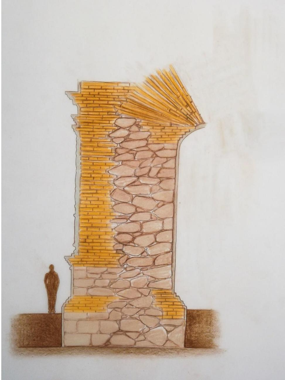
**Fig. 35 Propuesta del posible sistema constructivo empleado en el acceso principal de acuerdo con las calas realizadas durante su restauración. Dibujo realizado por Constantino Armendáriz Ballesteros a solicitud de Haydeé Orea para esta tesis.**
