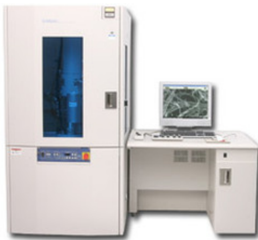
Figura 34.- Microscopio electrónico de barrido - Hitachi FE-SEM S-5500.
