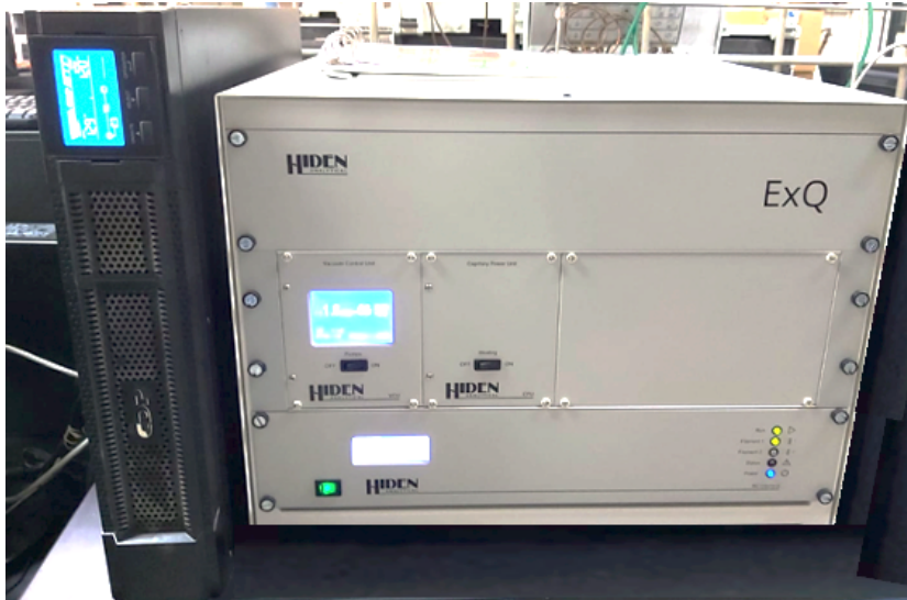
Figura 38.- Espectrómetro de masa ExQ Hiden Analytical.
