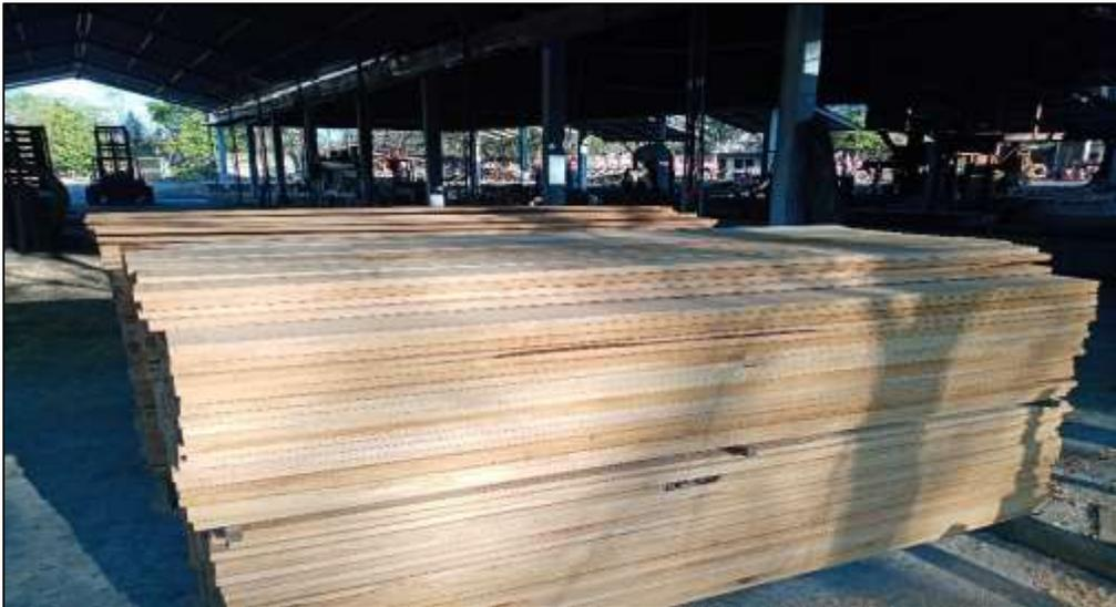
Madera de pino aserrada, cepillada y terminada con proceso de curación.
