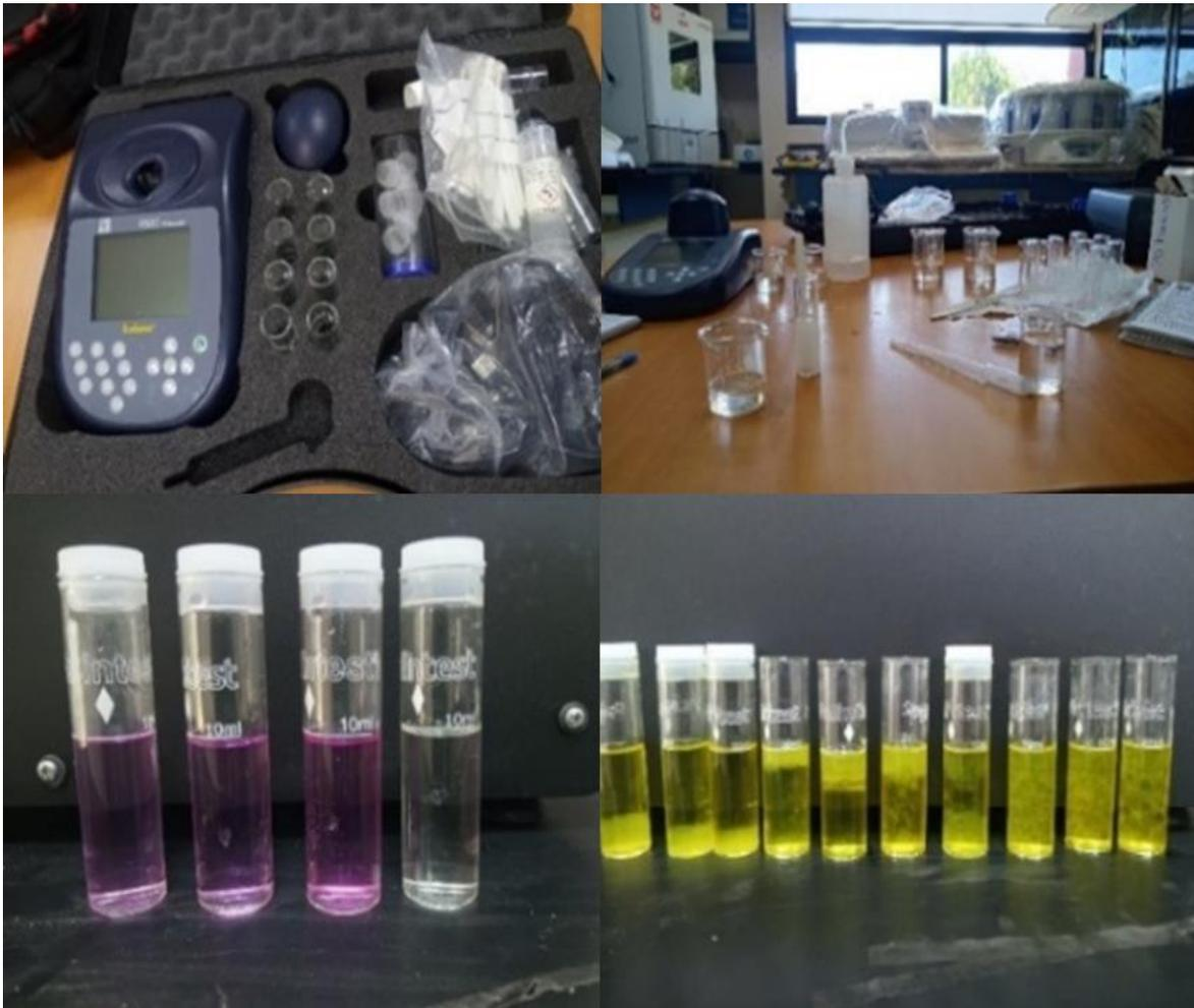
**Figura 8.** Análisis de los nutrientes a través de un fotómetro YSI 9500, de las aguas subterráneas para el cultivo de camarón *P. vannamei*.
