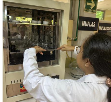
Figura 17. Muestra humedad dentro del horno
