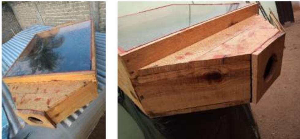
*Figura 63 Colector de placas planas terminado*
