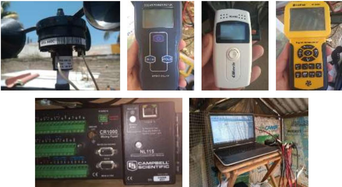
*Figura 214 Instrumentos para adquisición de datos*
