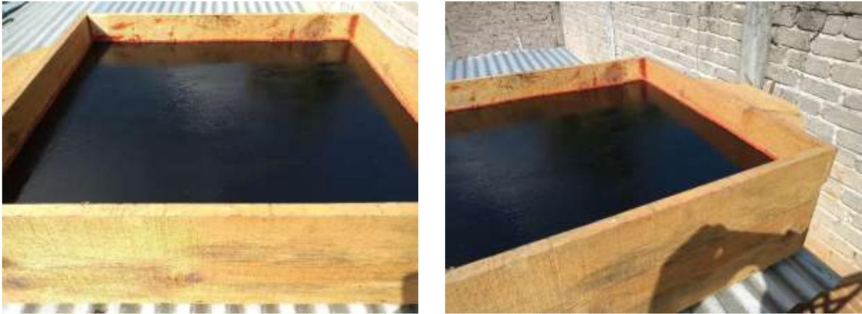
*Figura 11 Colector con placa aislante y placa absorbedora*
