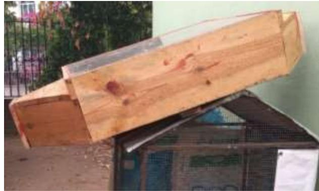
Figura 96 Colector de placas planas terminado
