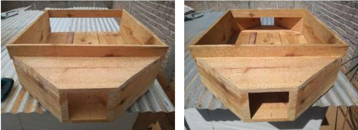
*Figura 9 Carcasa con sección trapezoidal para entrada y salida de aire*
