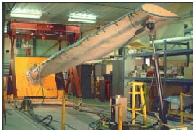
Figura 2.7. Prueba de desplazamiento forzado utilizando un actuador hidráulico.
