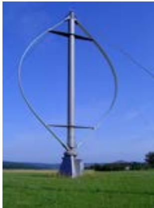
Figura 3.3. Rotor Darrieus. Fuente: [41].
