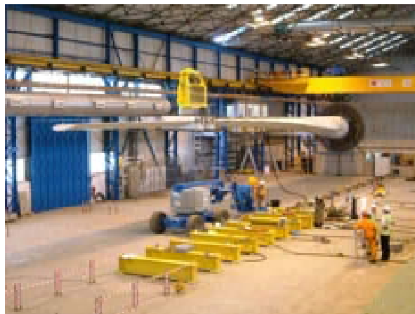
Figura 2.9. Primer equipo de prueba de fatiga de Narec: un sistema de masa resonante accionado por un sistema hidráulico.
