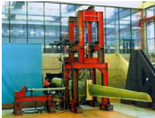
Figura 2.12. Prueba de dos ejes con actuadores hidráulicos. Fuente: [8]
