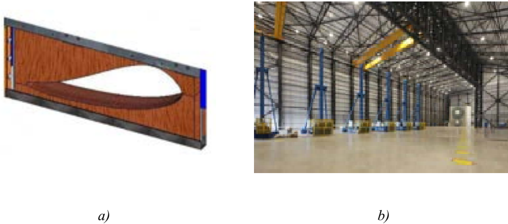
Figura 2.5. Monturas y winches utilizados en las pruebas estáticas de la pala: a) montura de madera y b) winches.
