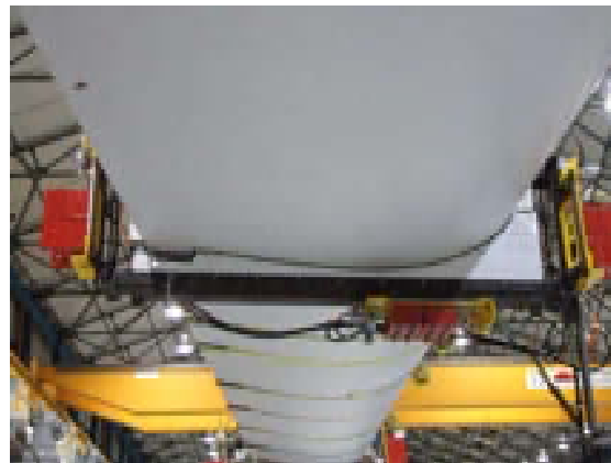
Figura 2.14. Configuración CRM de Narec para pruebas de doble eje. Fuente: [13]
