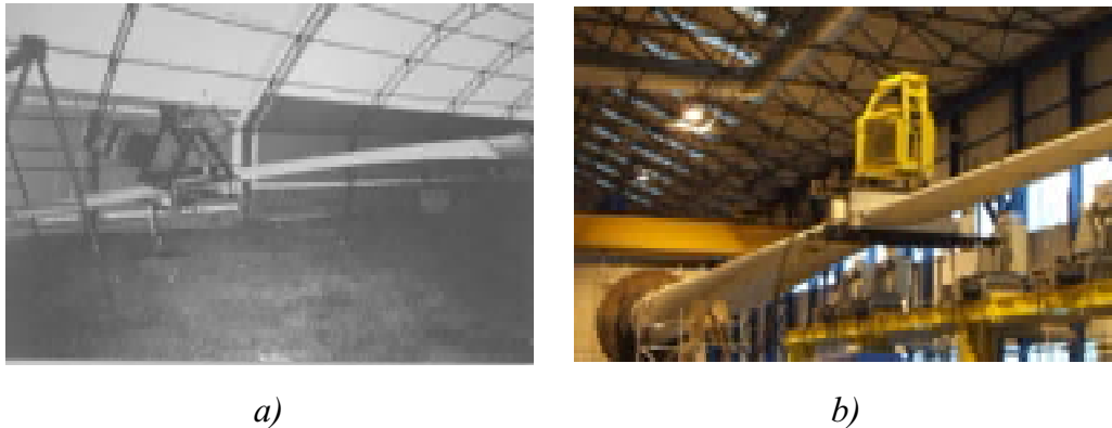
Figura 2.8. Excitación resonante para pruebas de fatiga: a) masa excéntrica giratoria y b) masa oscilante.
