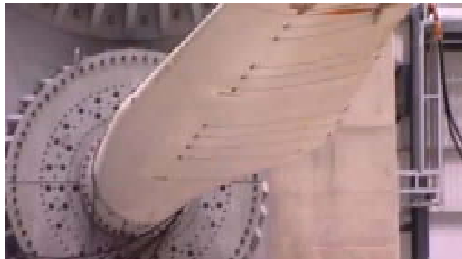
Figura 2.23. Arreglo de galgas extensométricas mecánicas en las pruebas de fatiga de una pala de aerogenerador
