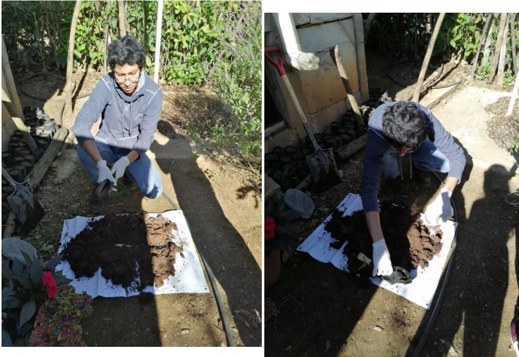
Figura 12. Muestreo mediante la técnica de cuarteo.
