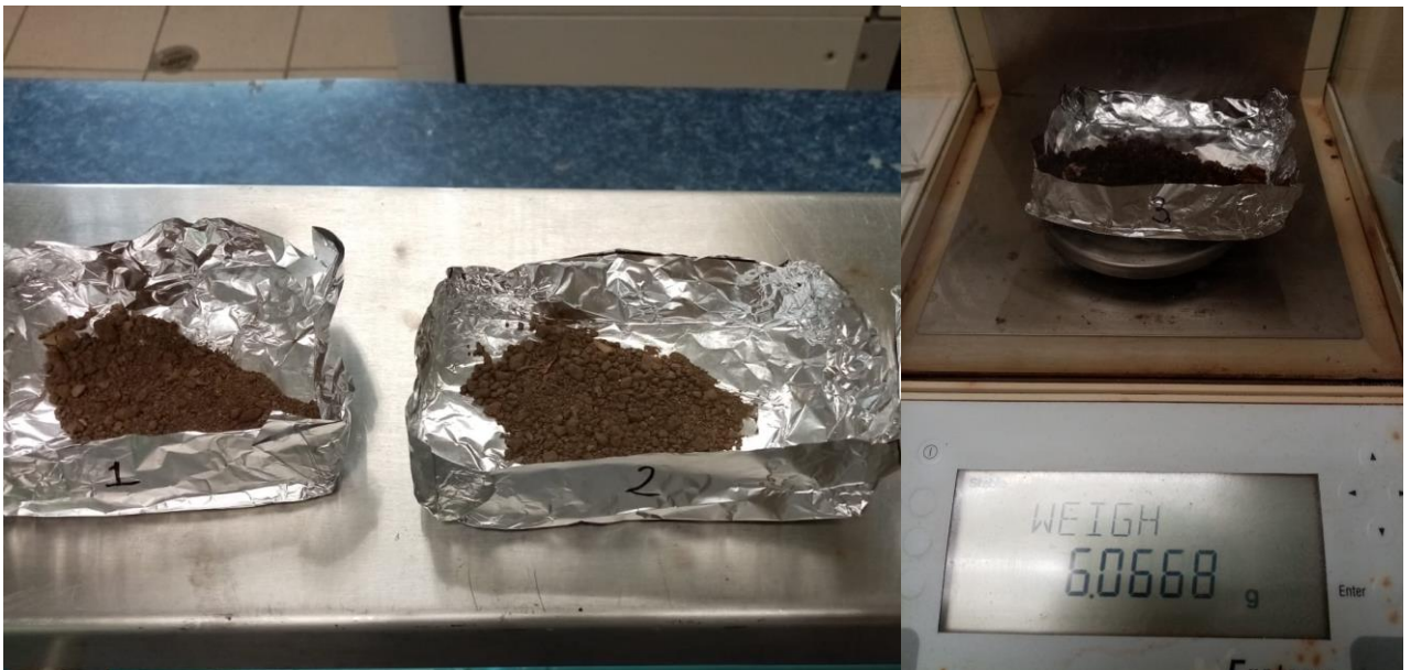
Figura 13. Determinación de los Sólidos Totales. Se observan las muestras secas.
