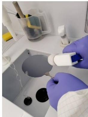
Figura 3.6 Limpieza de residuos del Tricloroetileno, con ayuda del agua desionizada
