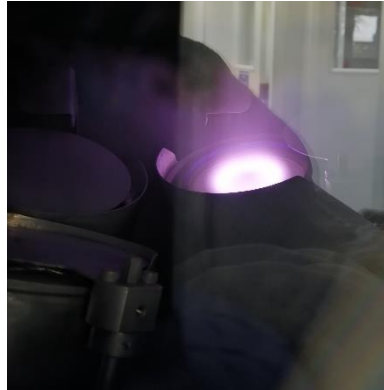
Figura 3.21 Plasma de iones de argón en el magnetrón sputtering
