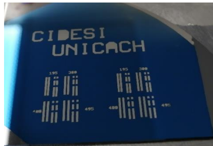
Figura 3.23 Depósito del Aluminio en un cuarto de oblea de \text{Si}/\text{SiO}_2/\text{IGZO}
