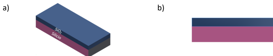
Figura 3.25 a) Esquema del proceso de fabricación del silicio con el crecimiento del óxido de silicio, b) vista frontal del silicio/óxido de silicio
