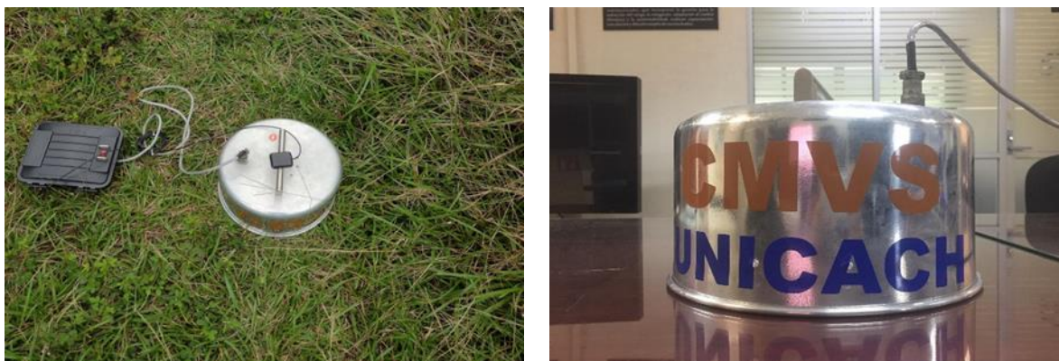
Imagen 10. Cámara de acumulación de gases.
