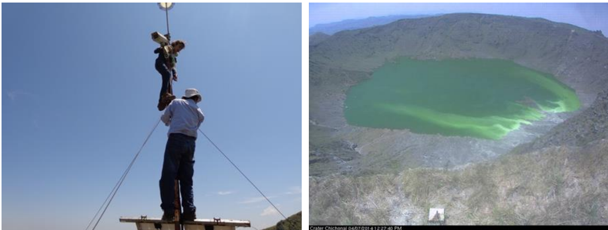
Imagen 2. Instalación de cámara para el monitoreo del volcán Chichón. Cortesía de Jon Selvas (2023).
