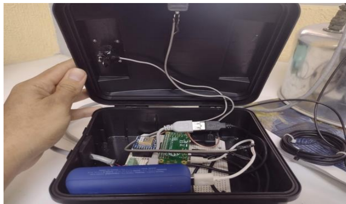
Imagen 11. Componentes de la cámara de acumulación.
