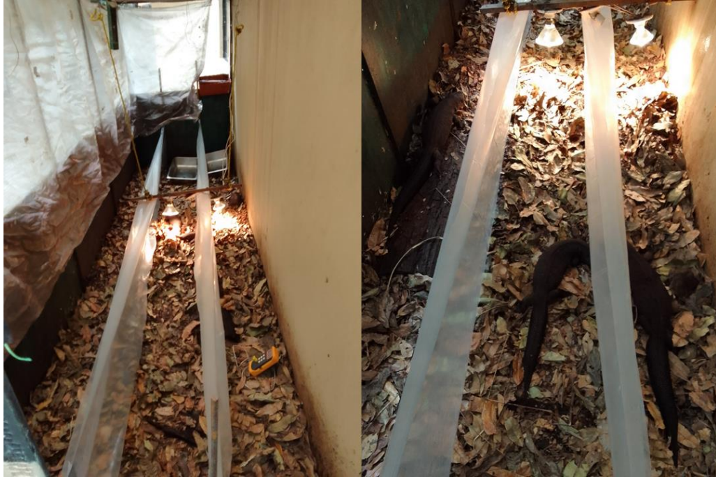
Figura 14. Gradiente térmico dividido en tres carriles donde los individuos se desplazan en búsqueda de la temperatura preferente.
