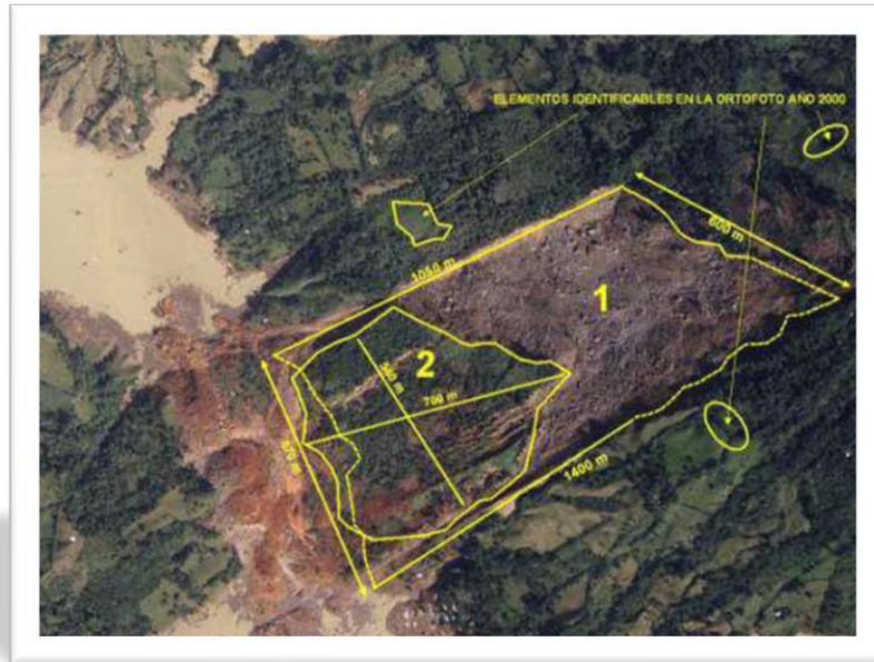
Figura 5. Deslizamiento traslacional, Juan de Grijalva, Ostucán. Fuente: Paz (2012).
