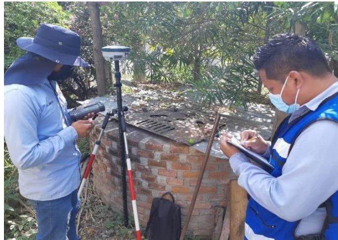
Fotografía 6: Obtención de las coordenadas de los pozos con el receptor GNSS (Hernández, M. 2021)
