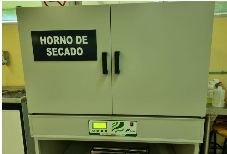
**Figura 6. Secado de malanga en en el horno de secado marca “Felisa” Modelo FE-294AD, Serie 1506003.**
