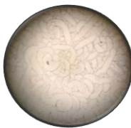
Figura III. 6 Película de Sol-Gel dopado con dos capas e intensidad media. (10X)
