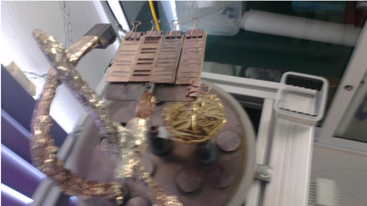
Figura III. 4 Electrodo de cobre por método de evaporación térmica en vacío
