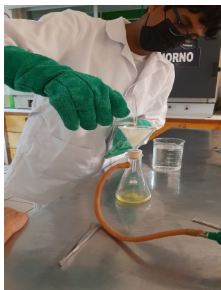
Figura 9 Filtrado de Muestra digerida con reactivo S-K.
