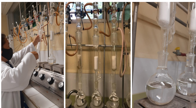
Figuras 4, 5 y 6 Extracción de Grasa Cruda por el Método Soxhlet
