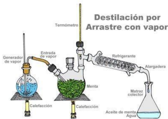
Fig. 2 Esquema de un equipo de destilación por arrastre (Peredo-Luna et al., 2009).
