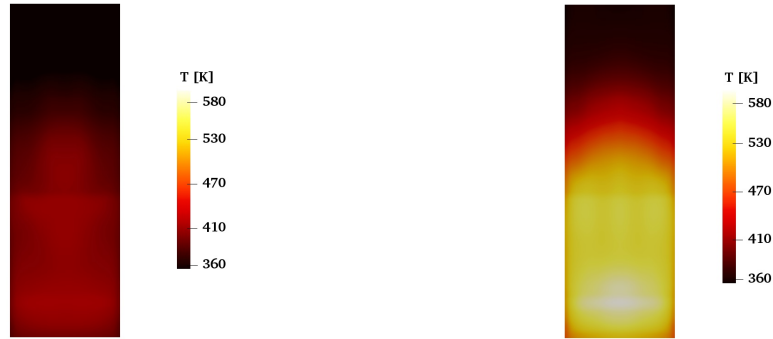
Figura 5.5: Isocontornos de temperatura en el comal para los valores de potencia de fuego bajo y alto ( t = 17 \text{ min} ): a) 5.183 and b) 12.981 kW .
