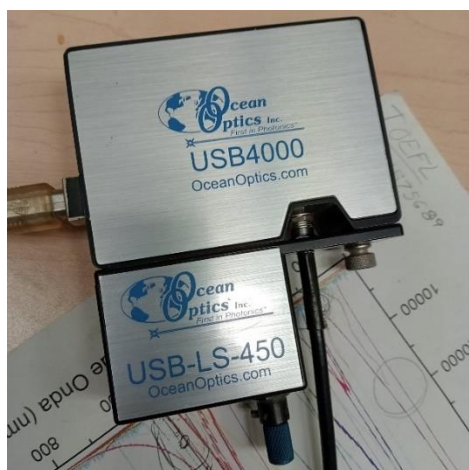
Figura 26. Espectrómetro Ocean Optics Inc. USB4000. Archivo propio
