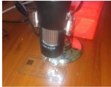
Figura 18. Calibración del microscopio digital. Archivo propio
