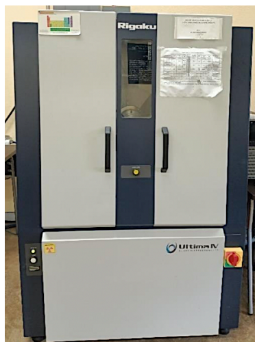
Figura 32.- Difractómetro de Rayos X Rigaku Ultima IV [114].
