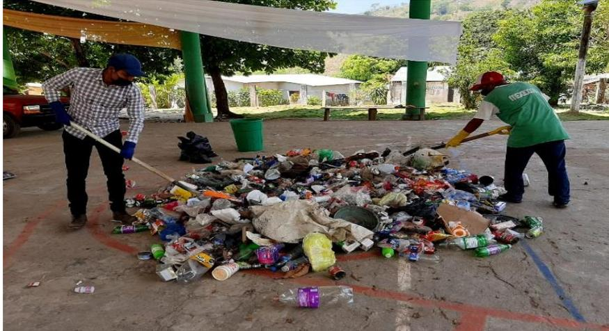
*Figura 28.- Homogenización de los residuos*
