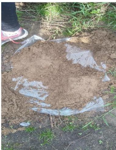
Fig 9. Retiro de 2 extremos de la torta hasta quedar 2 kilos de muestra
