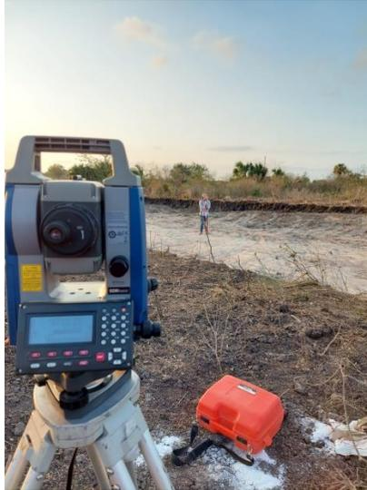
Figura 12 Levantamiento topográfico del despalme
