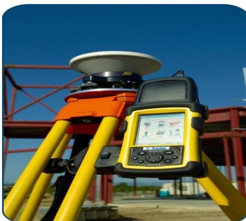
Figura 9 Sistema de posicionamiento global Gps doble frecuencia
