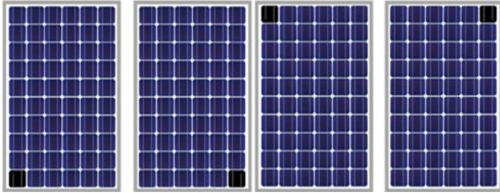
Ilustración 14. Proyección de sombra en una celda del módulo en las cuatro esquinas [Elaboración propia].
