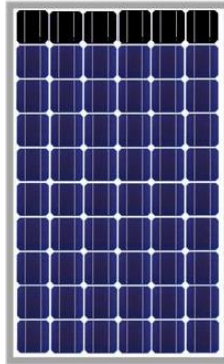
Ilustración 15. Proyección de sombra en una línea de celdas de forma horizontal del módulo FV [Elaboración propia].
