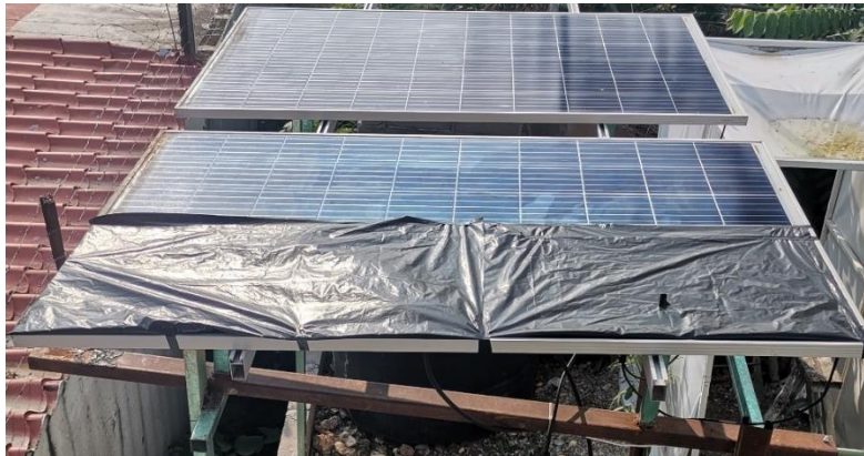
Ilustración 50. Sistema fotovoltaico interconectado a red con una sombra en la mitad de las celdas de forma vertical del extremo izquierdo de uno de los módulos del sistema.
