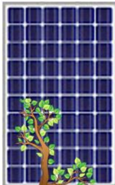
Ilustración 21. Proyección de la sombra de una rama sobre un módulo FV [Elaboración propia].
