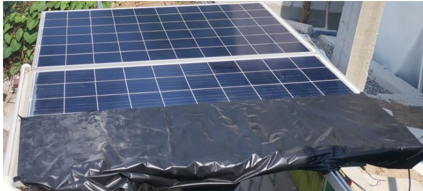
Ilustración 41. Módulo Fotovoltaico con la mitad de sus celdas cubiertas.
