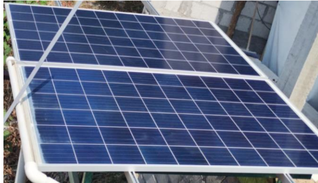
Ilustración 40. Módulo Fotovoltaico con sombra de una varilla o tubo.
