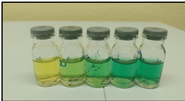
Figura 13. Muestras pigmentadas para la realización de la curva de calibración de amonio ( \text{NH}_4^+ ).
