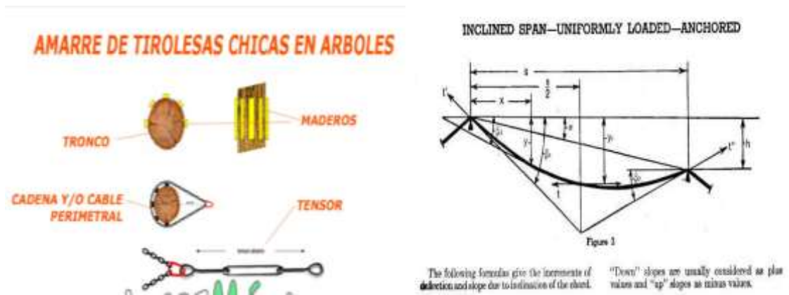
Imagen 7 Recomendación de la empresa para los Amares e inclinación de la tirolesa
