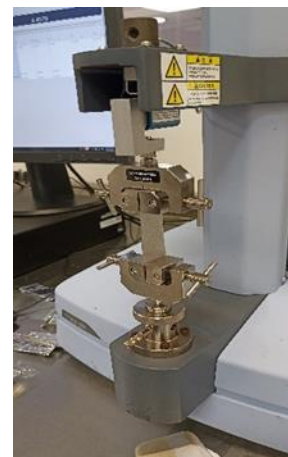
Ilustración 39 Texturómetro de ensayo EZ
