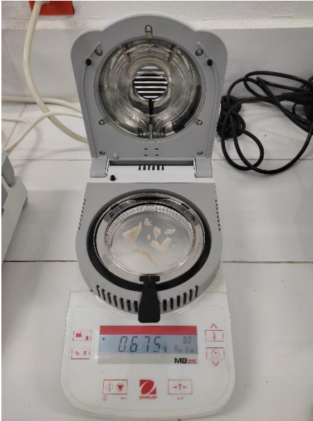
Ilustración 30 Prueba de humedad
