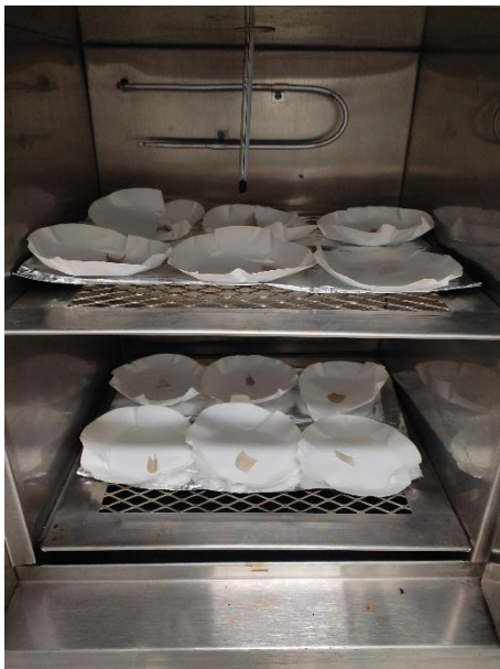
Ilustración 34 Secado de las películas por 24 horas
