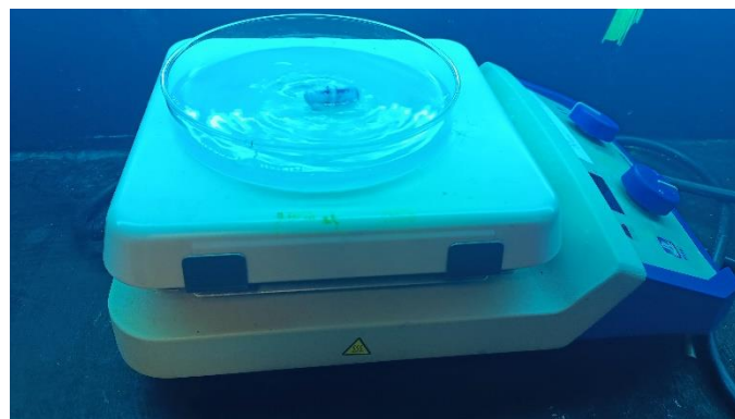
Figura 61. Evaluación de ZnO expuesta a luz UV.
