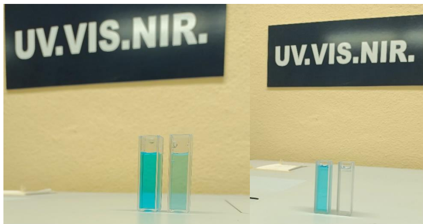
Figura 64. Uso de cubetas de cuarzo para la medición de absorbancia.
