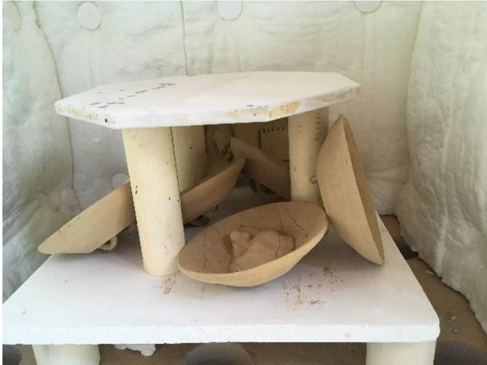
Figura 149 Colocación de los platos en el horno para la quema en Querétaro.
