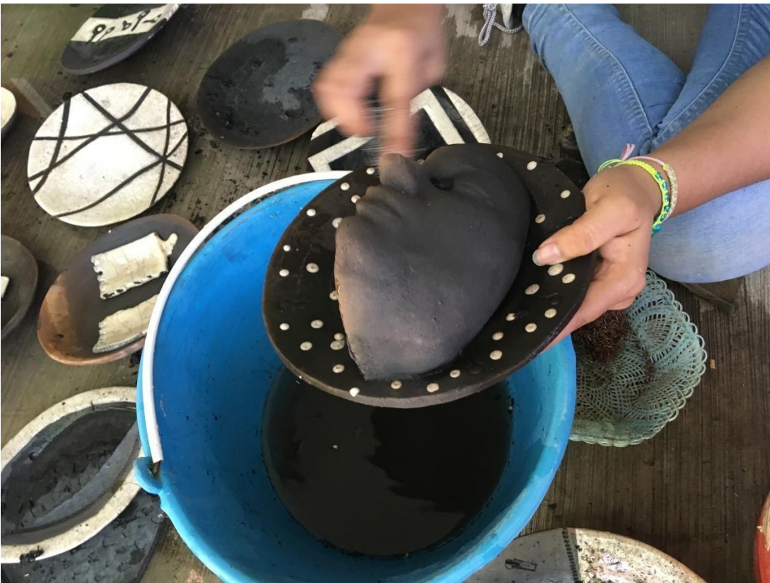
Figura 227 Con una fibra de aluminio se quitaron los excesos de aserrín.
