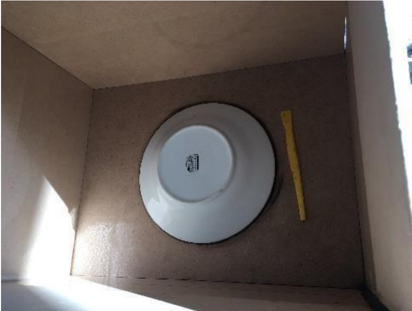
Figura 63 Encofrado sellado por dentro vaciado, en este punto utilizamos la esponja y el pincel para dispersar una capa fina de vaselina usada como desmoldante en el plato sin que queden excesos o grumos.
