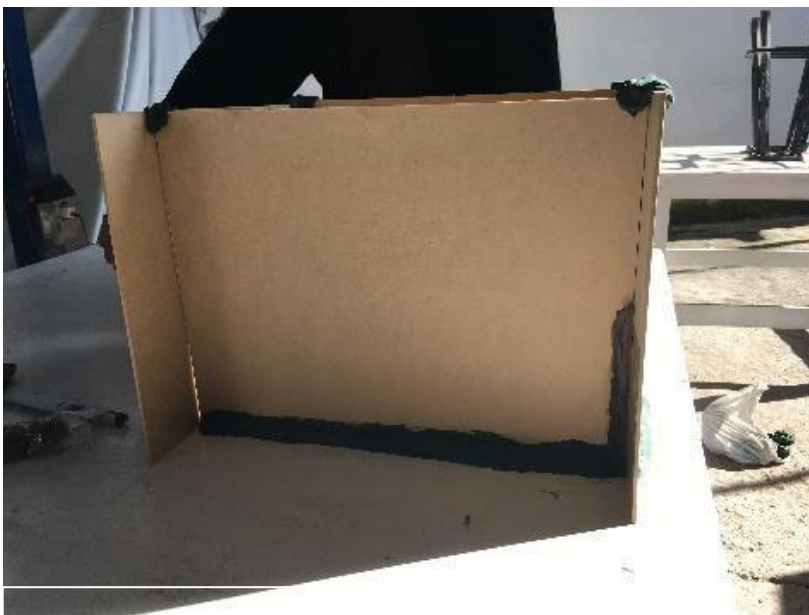
Figura 64 Encofrado sellado por fuera
