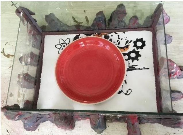
Figura 67 Encofrado con paredes de vidrio
