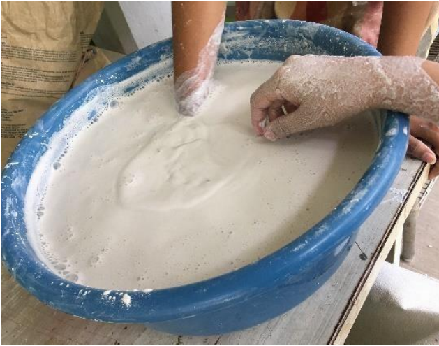
Figura 72 Mezcla del agua y yeso
