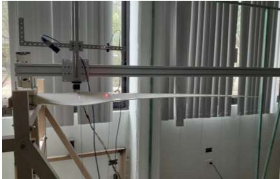
Figura 3.8. Arreglo de las pruebas experimentales a la pala.
