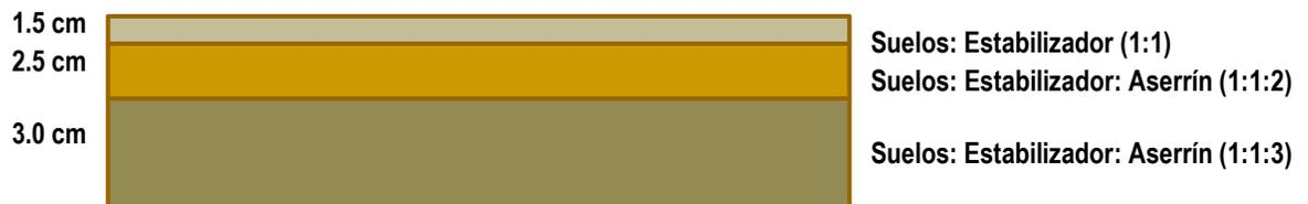
**Figura 3.3.** Distribución de las muestras tratadas por capas en la pieza
