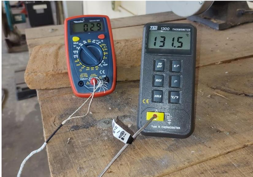
**Figura 3.10.** Monitoreo de temperatura dentro del horno y en la cara exterior de la pieza cerámica
