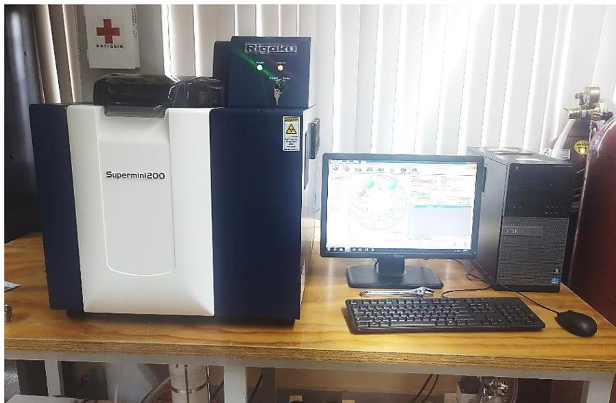
**Figura 3.6.** Espectrómetro de fluorescencia de rayos X secuencial (WDXRF)
