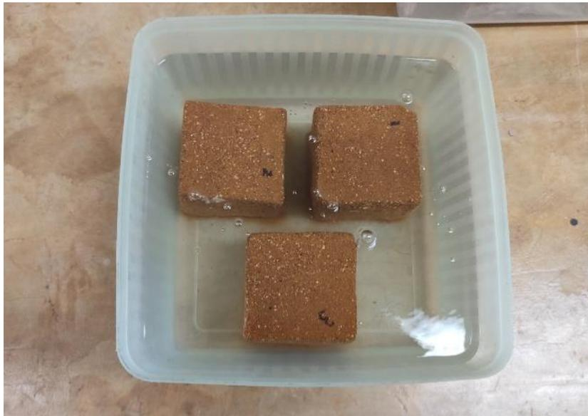
*Figura 3.8. Prueba de absorción en tres muestras representativas*
