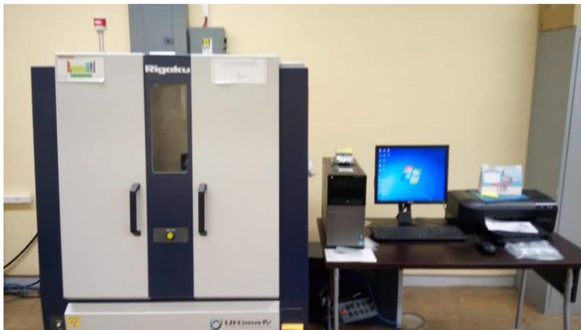
*Figura 3.4. Equipo de difracción de rayos X*
