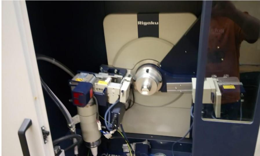
**Figura 3.5.** Colocación de la muestra en el difractómetro de rayos X
