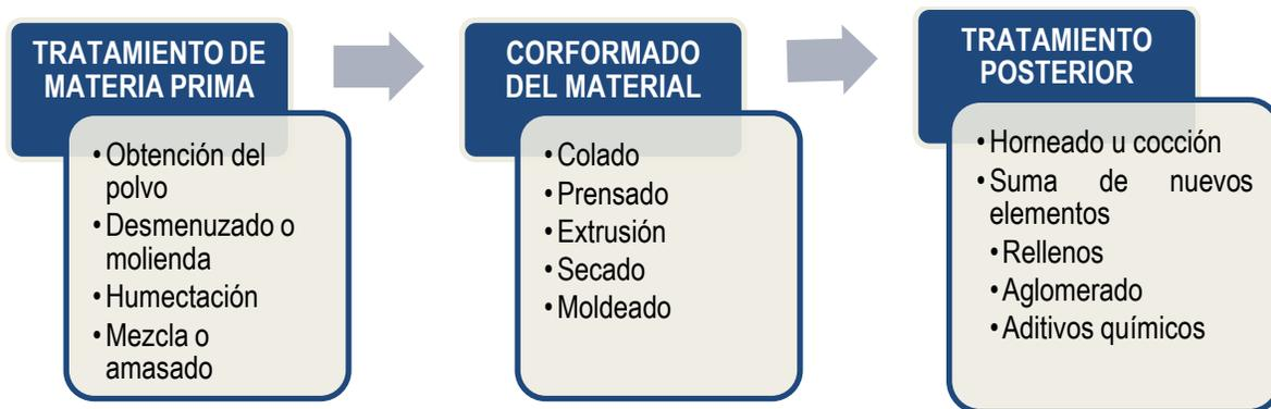
**Figura 2.3.** Proceso de fabricación de cerámicos de arcillas
