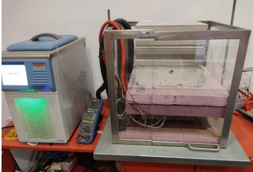
**Figura 3.7.** Equipo de medición de conductividad térmica
