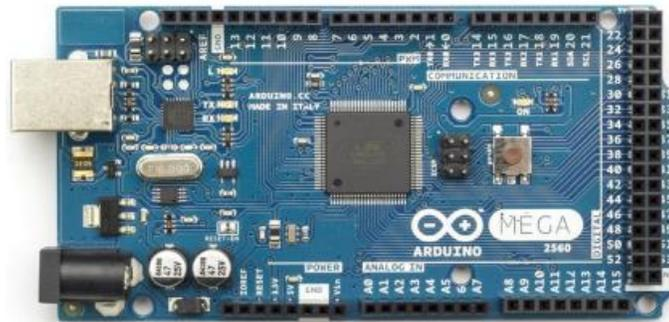
*Figura 2.30. Arduino mega [24].*
