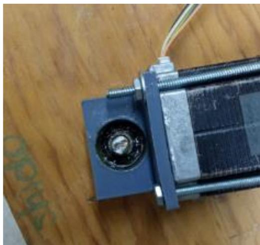
**Figura 4.15.** Instalación de la base de motor con la base de la estructura.
