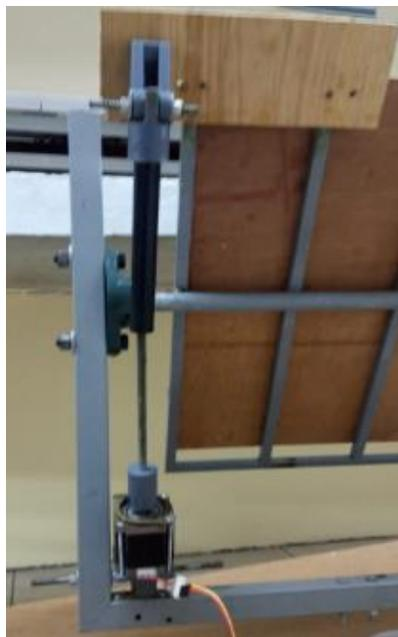
**Figura 4.17.** Actuador lineal en el eje cenital.
