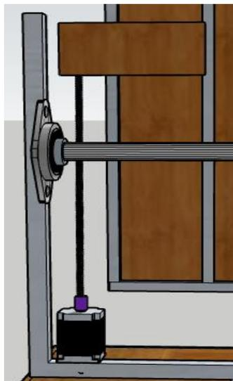
*Figura 3.13. Posición del motor en el eje cenital.*
