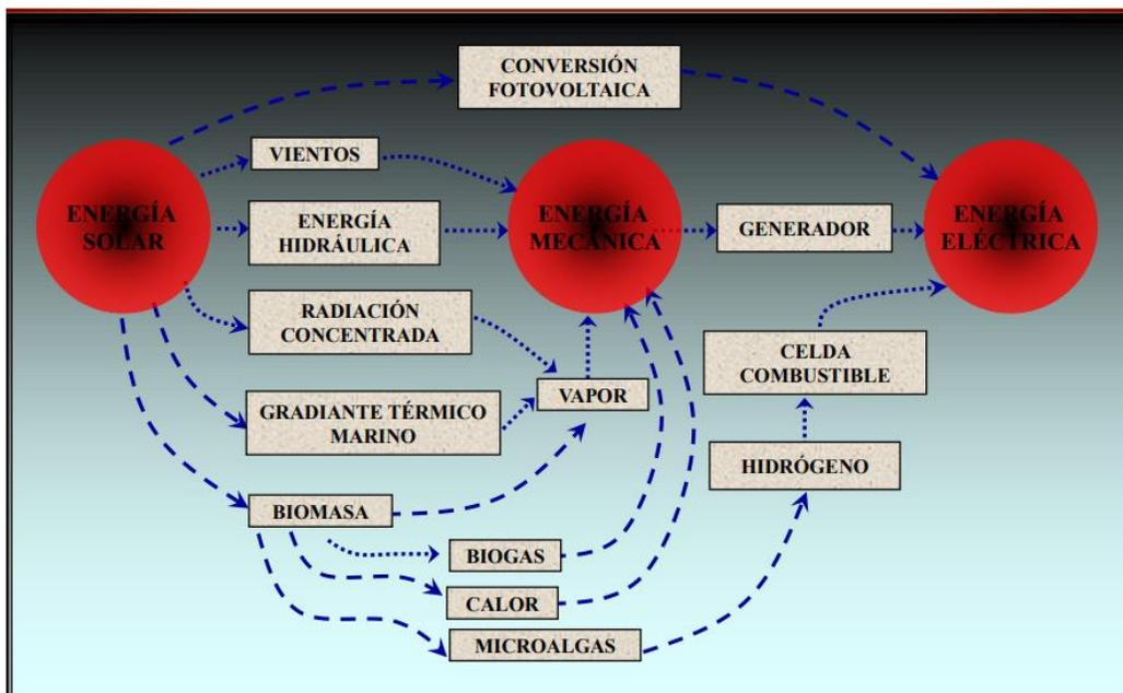
Figura 2.4. Transformación de la energía solar [8].
