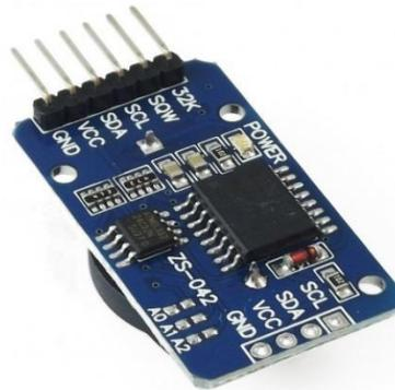
**Figura 3.23.** Reloj en tiempo real RTC.
