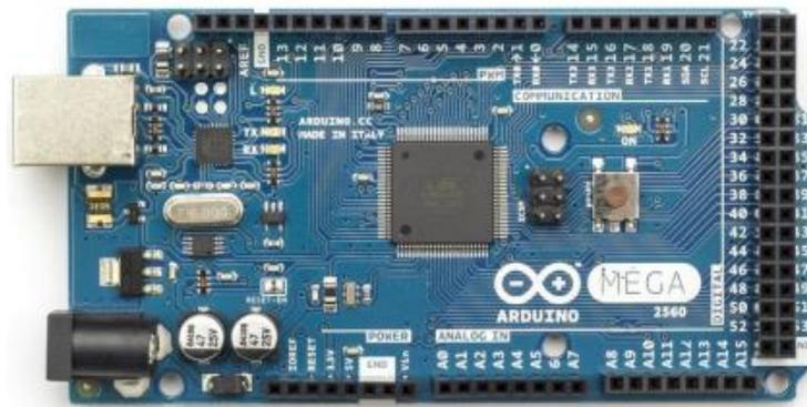
*Figura 3.19. Arduino Mega [24].*
