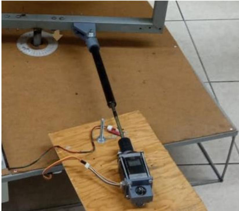
**Figura 4.14.** Actuador lineal del eje azimut.
