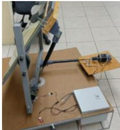
**Figura 4.13.** Actuator lineal en el eje azimut y cenital.
