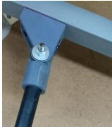
**Figura 4.16.** Conexión del actuador lineal azimuth con el soporte de la estructura.
