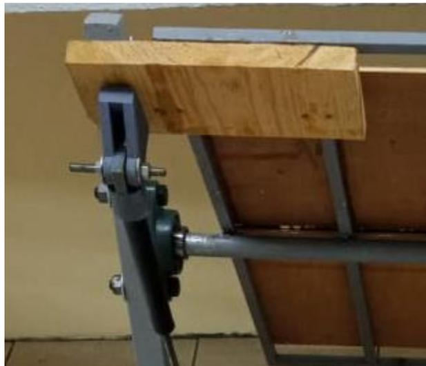
**Figura 4.20.** Conexión del actuador lineal con la base del espejo.
