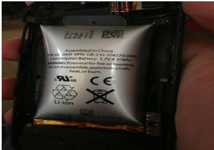
**Figura 7.** Baterías a punto de explotar.
