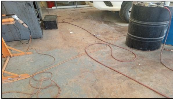
Fig. N°18 Manguera del compresor de aire, fuera de lugar.
