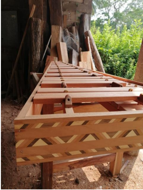
Construcción de una marimba tenor. (Faldón y teclas)
