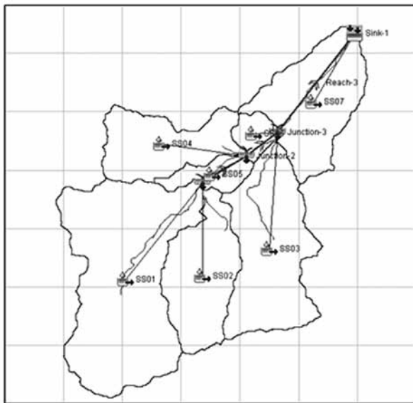
FIGURA 3 Modelo hidrológico conceptual semidistribuido de la cuenca Salinas.
